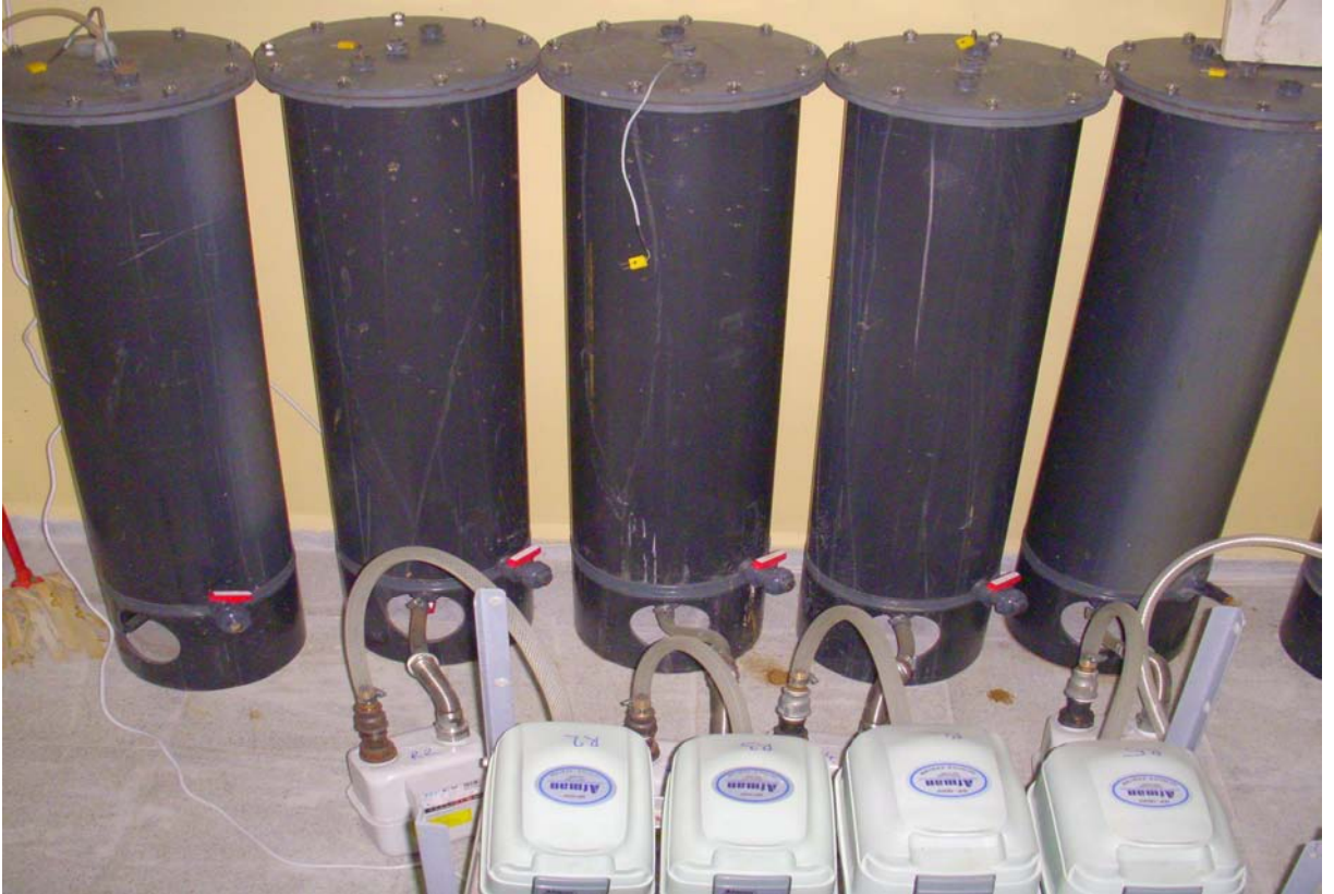
Anaerobik ve aerobik reaktörlerin işletme aşamasına ait görüntü
