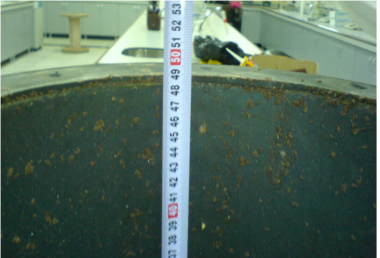
Reaktörler boşaltılmadan hemen önce çökme oranının ölçülmesine ait görüntü
