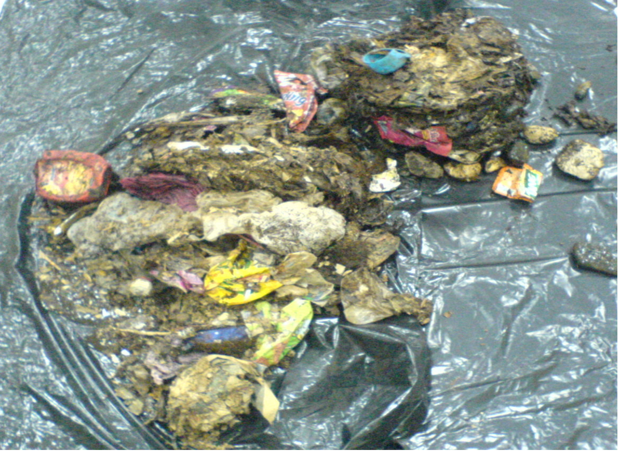
Aerobik reaktörlerden boşaltılan katı atığın görüntüsü
