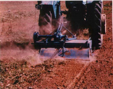
Resim -11: Yeşil Gübrelerin Rotavator ile Parçalanması
