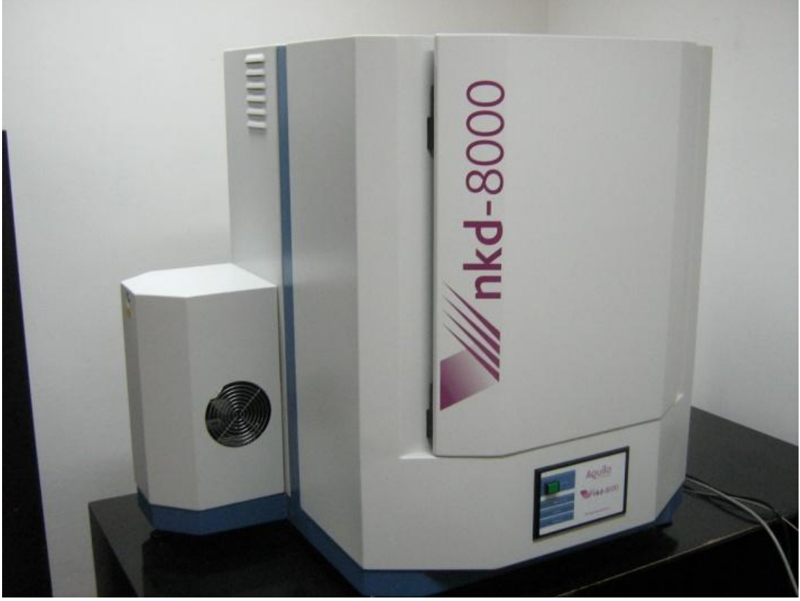
Şekil 4.5. Aquila nkd-8000 UV-VIS-NIR spektrofotometresi dış görünümü.
