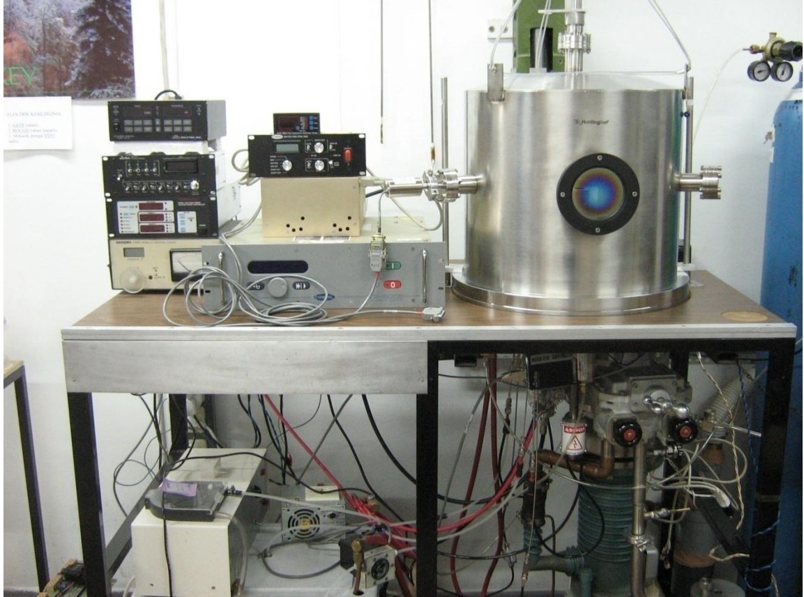
Şekil 4.1. İki kafalı RF/DC magnetron kopartma (sputtering) sistemi.
