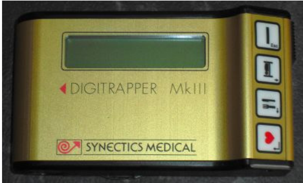
Resim 2 - Digitrapper MKIII (Synectics Medical, İsveç) pH ölçüm cihazı
