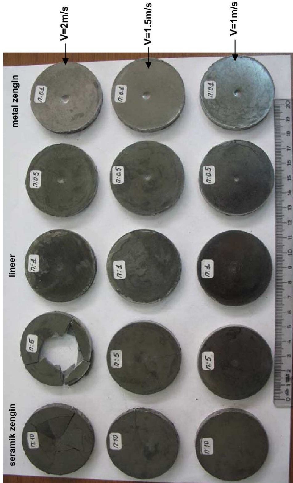
Şekil 6.7. Çarpma deneylerinden sonra Al-SiC fonksiyonel kademelendirilmiş dairesel plakalar.
