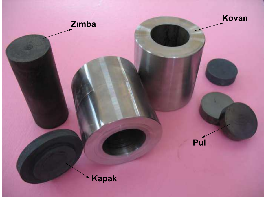
Şekil 6.5. Fonksiyonel kademelendirilmiş plaka üretimi için sıcak iş çeliğinden AISI2344 imal edilmiş kalıplar
