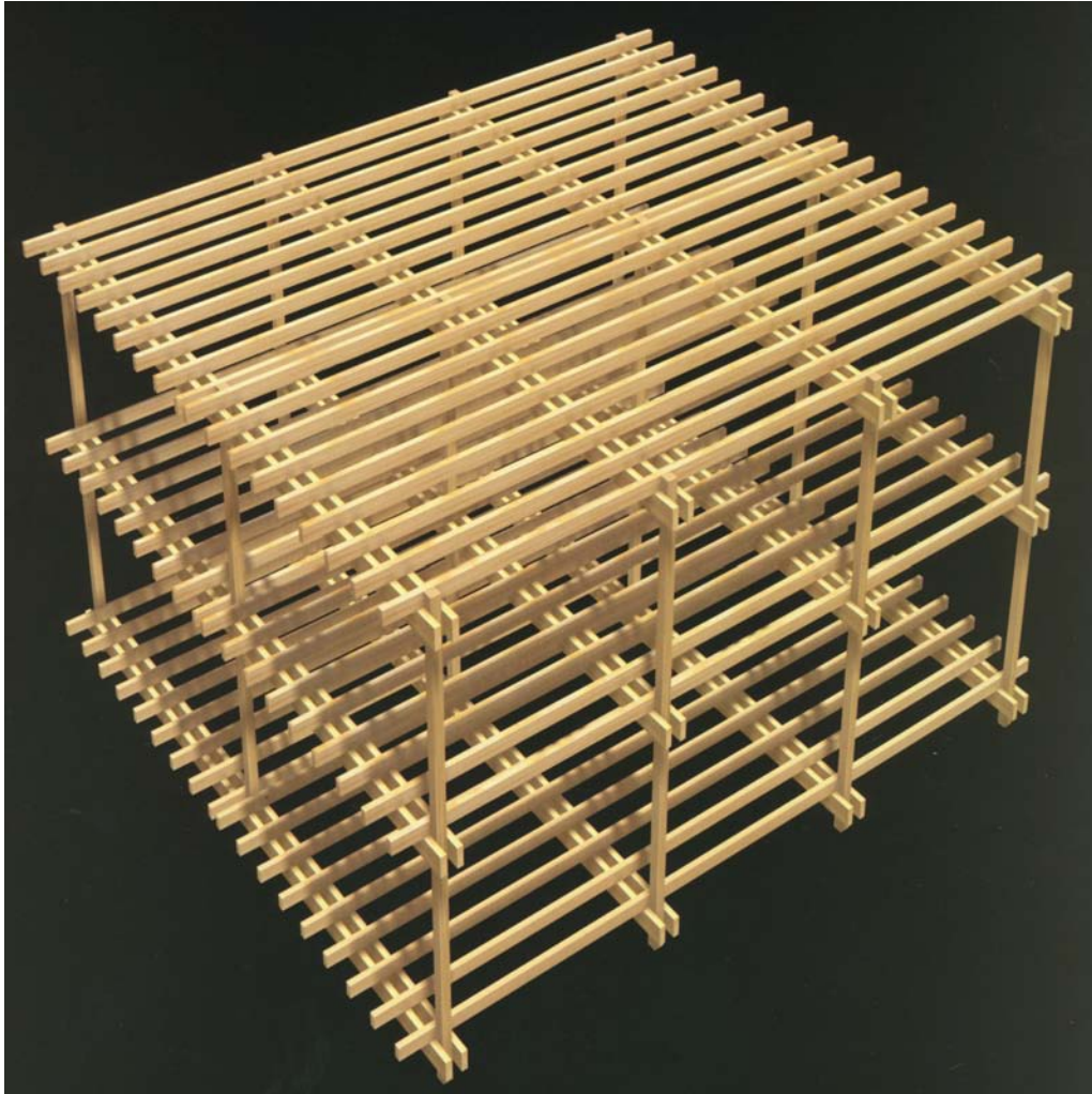
Şekil 4.17. Taşıyıcı elemanların üçüncü boyutta gösterimi (Pfeifer ve ark. 1998)
