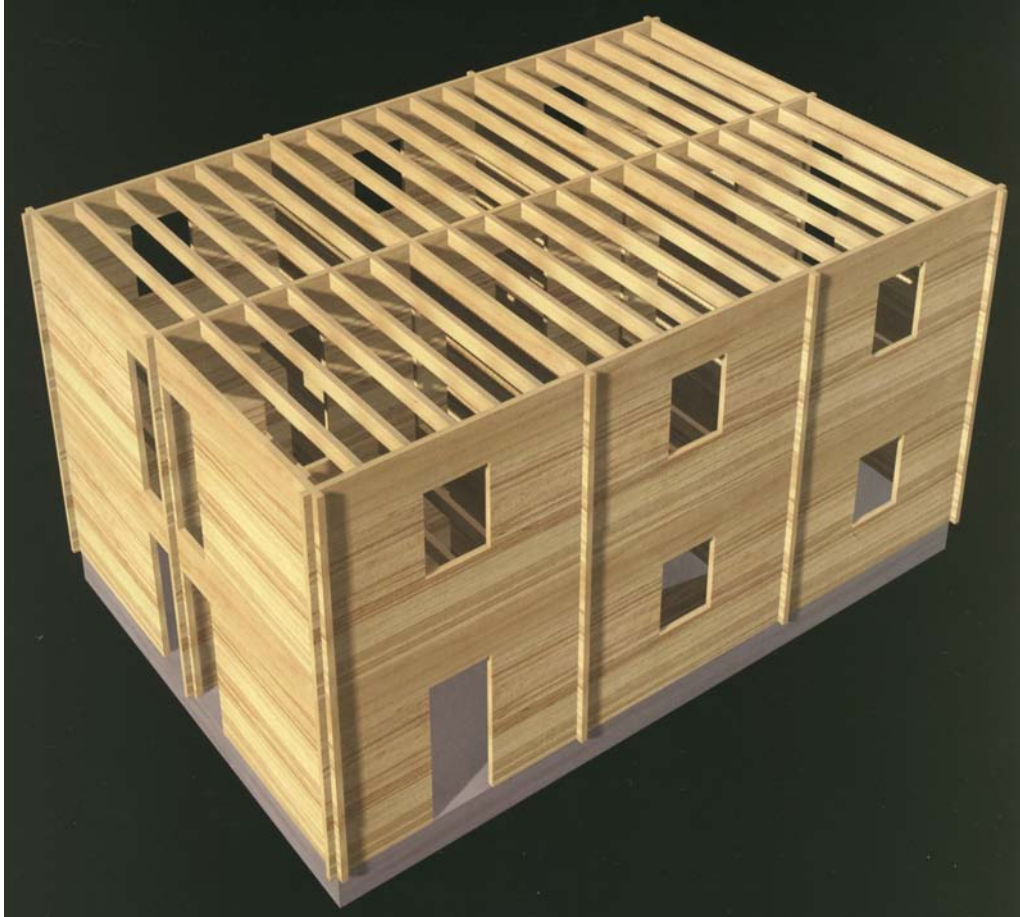
Şekil 4.11. Taşıyıcı ve bölücü elemanların üçüncü boyutta gösterimi (Pfeifer ve ark. 1998)
