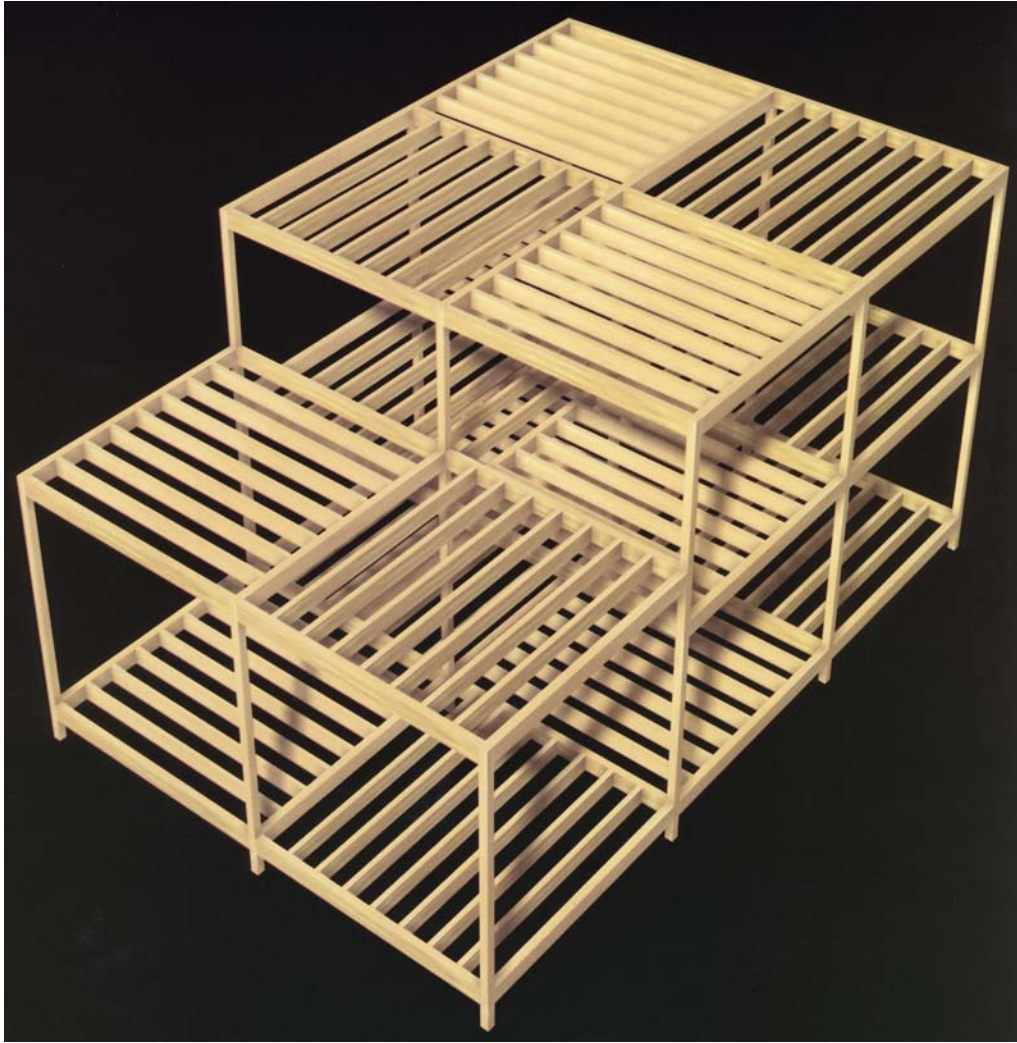
Şekil 4.34. Taşıyıcı elemanların üçüncü boyutta gösterimi ( Pfeifer ve ark. 1998 )
