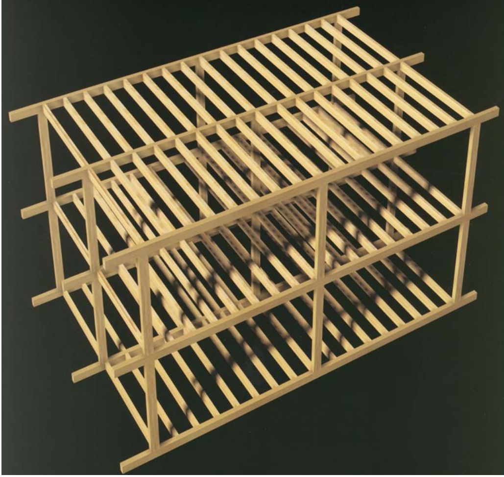
Şekil 4.29. Taşıyıcı elemanların üçüncü boyutta gösterimi (Pfeifer ve ark. 1998)
