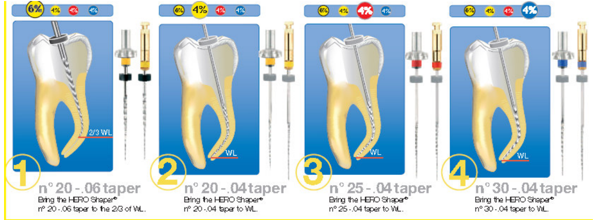
Şekil 1.11: HeroShaper zor kanallarda kullanım şeması
