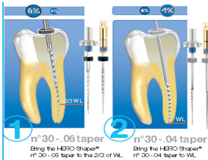
Şekil 1.13: HeroShaper kolay kanallarda kullanım şeması
