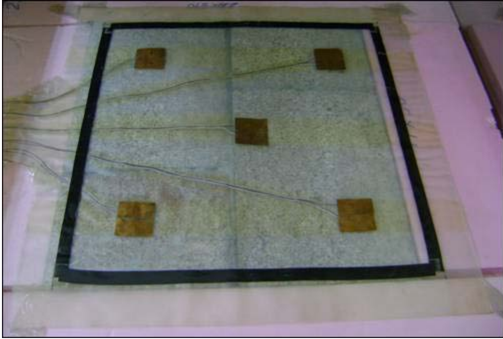
Şekil 3.28. Sıcak Folyonun Yerleştirilmesi
