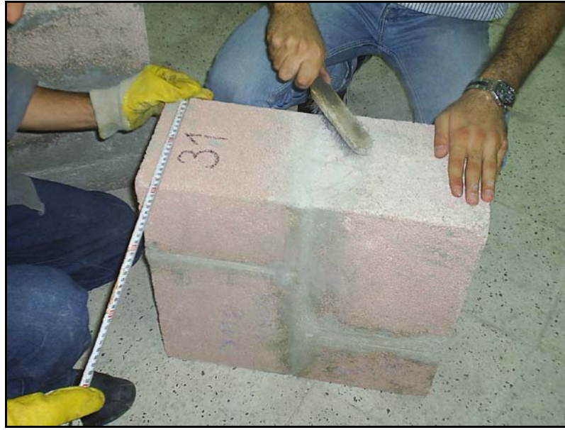
Şekil 3.22. Duvar Bloklarındaki Harç Tabakalarının Düzlenmesi
