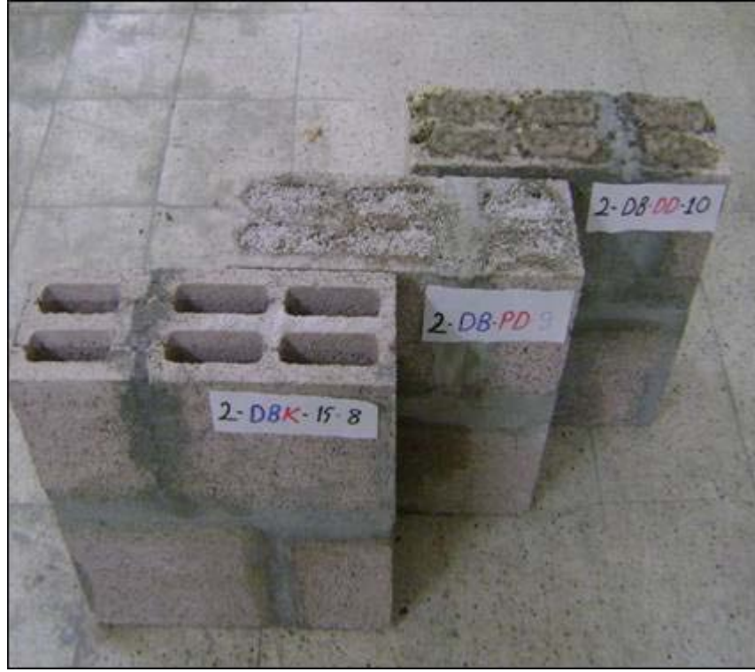
Şekil 3.24. Dolgulu Duvar Bloklarının Laboratuvar Ortamında Kurutulması
