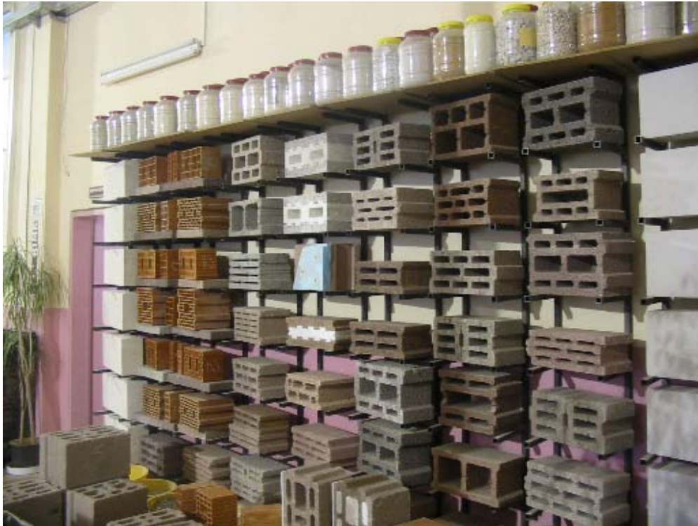
Şekil 2.20. Bimsbetondan Mamul Duvar Blokları Örnekleri-Isparta
