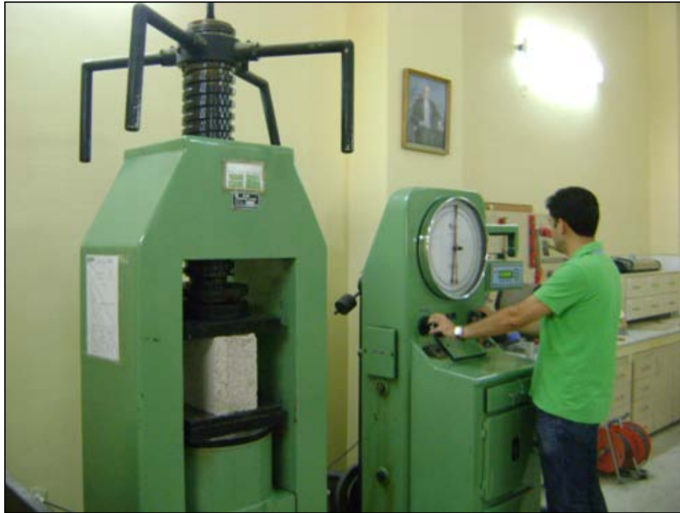
Şekil 3.17. Duvar Bloklarının Basınç Dayanımlarının Belirlenmesi
