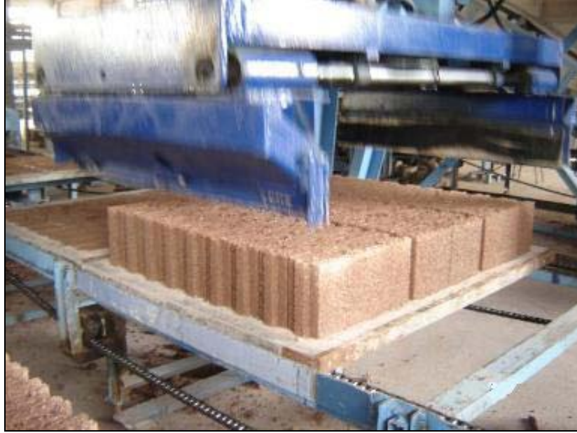
Şekil 3.12. Duvar Bloklarının Paletten Alınması
