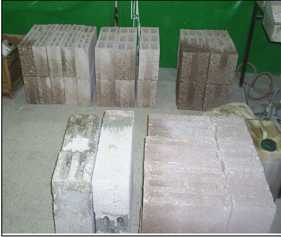
Şekil 3.23. Hazırlanan Bir Kısım Duvar Bloklarının Kurumaya Bırakılması
