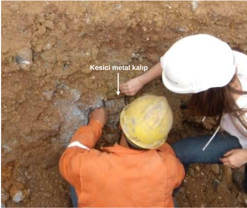
Şekil 5.3. Araştırma çukurundan kesici metal kalıp ile örselenmemiş örnek alımı.
