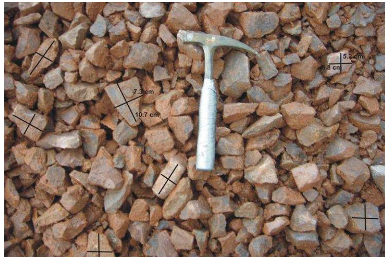
Şekil 6.6. Kırmataş yığınlarına ait parçaların uzun kenar-kısa kenar boyutlarının fotoanaliz yöntemiyle belirlenmesi.
