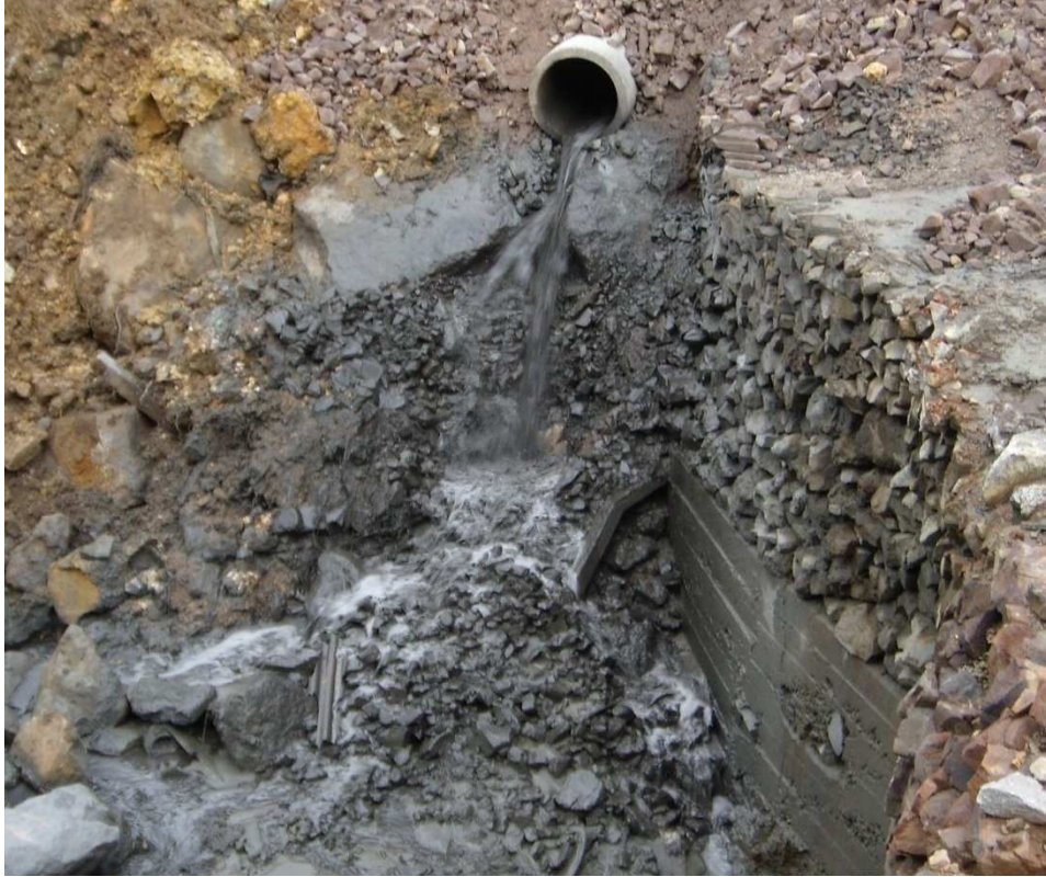
Şekil 3.8. Su ile karıştırılmış atık malzemenin cevher zenginleştirme tesisinden doğal topoğrafik eğim boyunca akıtılması.
