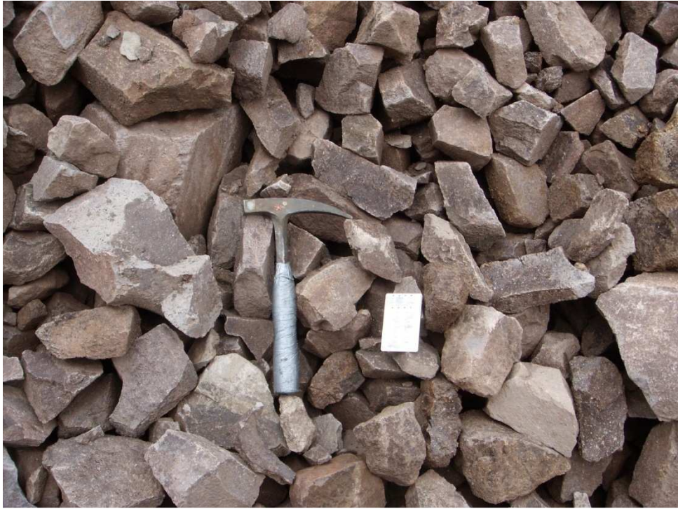
Şekil 5.8. Dolgu malzemesi olarak kullanılması planlanan kırmataş yığınının fotoanaliz amacıyla çekilmiş bir görünüm.
