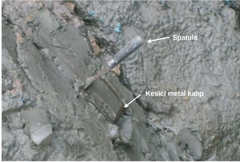
Şekil 5.4. Atıktan kesici metal kalıplarla örselenmemiş örnek alımı.
