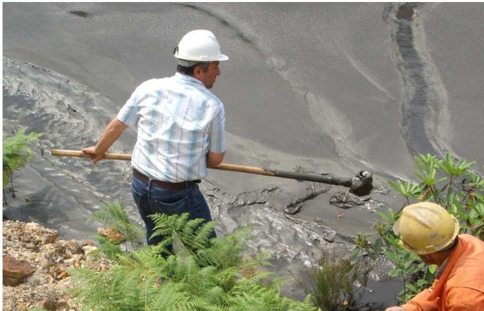
Şekil 5.5. Alt kottaki atık barajından örselenmiş örnek alımı.
