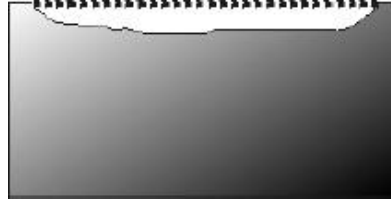
Şekil 2.1 Homojen dağılımlı korozyon.
