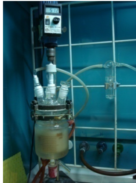
Şekil 3.1. Mekanik karıştırıcı - ceketli kesikli reaktör.
