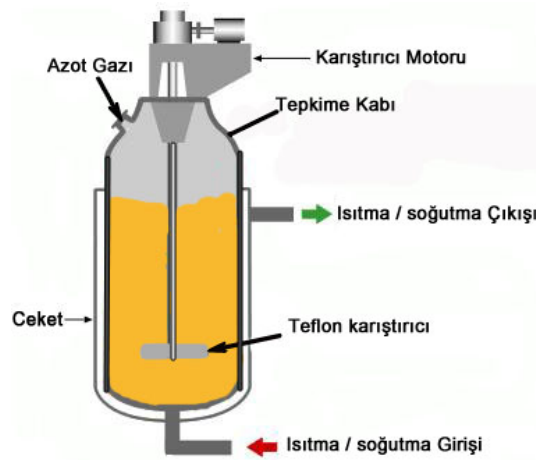
Şekil 3.6. Sülfonasyonun gerçekleştirildiği reaktör.
