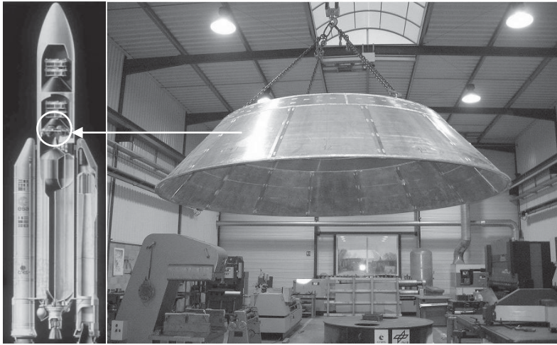
Resim 4.7. Ariane 65 isimli rokette kullanılan alüminyum köpükten yapılmış koni biçimli adaptör [50]
