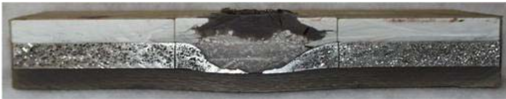
Resim 4.6. Patlamalara karşı integral zırh malzemesi olarak performansı değerlendirilmiş alüminyum köpüğün kesiti [47]
