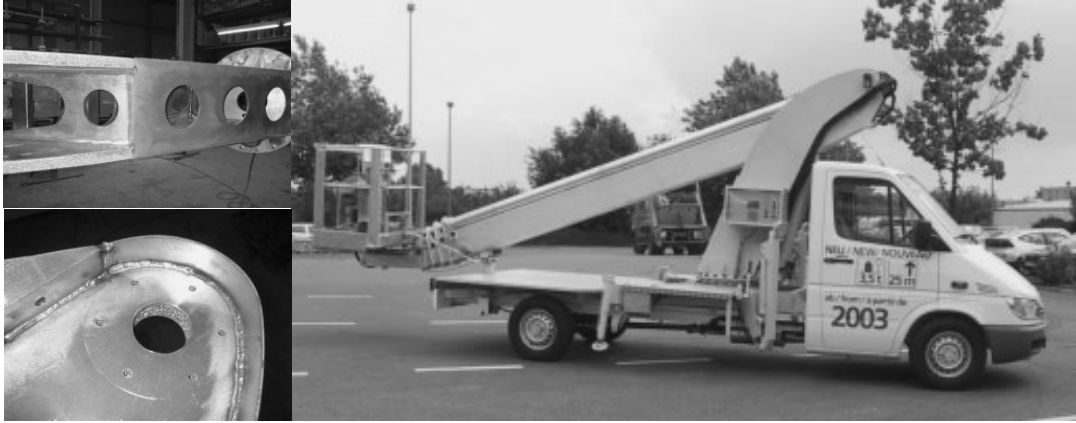
Resim 4.5 Alüminyum sandviç panelden yapılmış bir kaldırma kolu [49]
