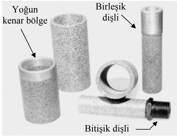
Resim 4.9. Alüminyum köpükten yapılmış susturucular [53]
