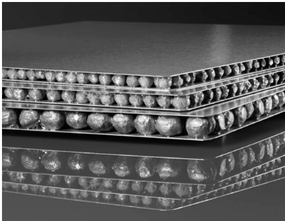
Resim 3.7. APM köpük parçalardan üretilmiş sandviç yapı [41]
