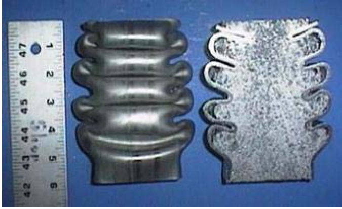
Resim 4.1. %58 oranda deforme edilmiş, içerisi alüminyum köpük ile doldurulmuş ve boş olan paslanmaz çelik profillerin kesitleri [47] (ilk boy: 305 mm, çarpışma uzunluğu: 177 mm)
