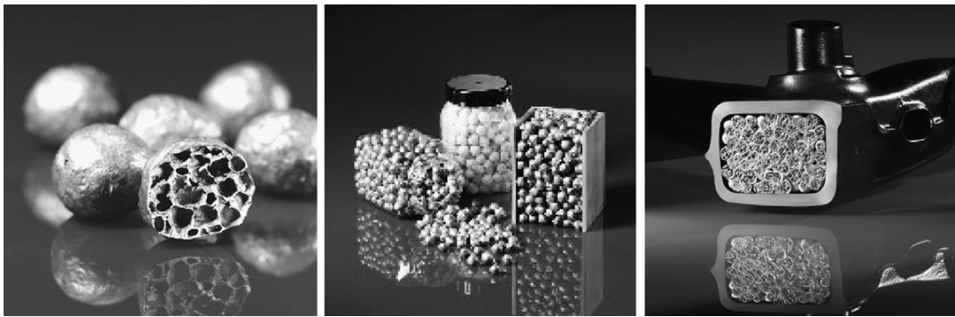
Resim 3.5. Alüminyum köpük küreler ve örnek uygulamaları [43]
