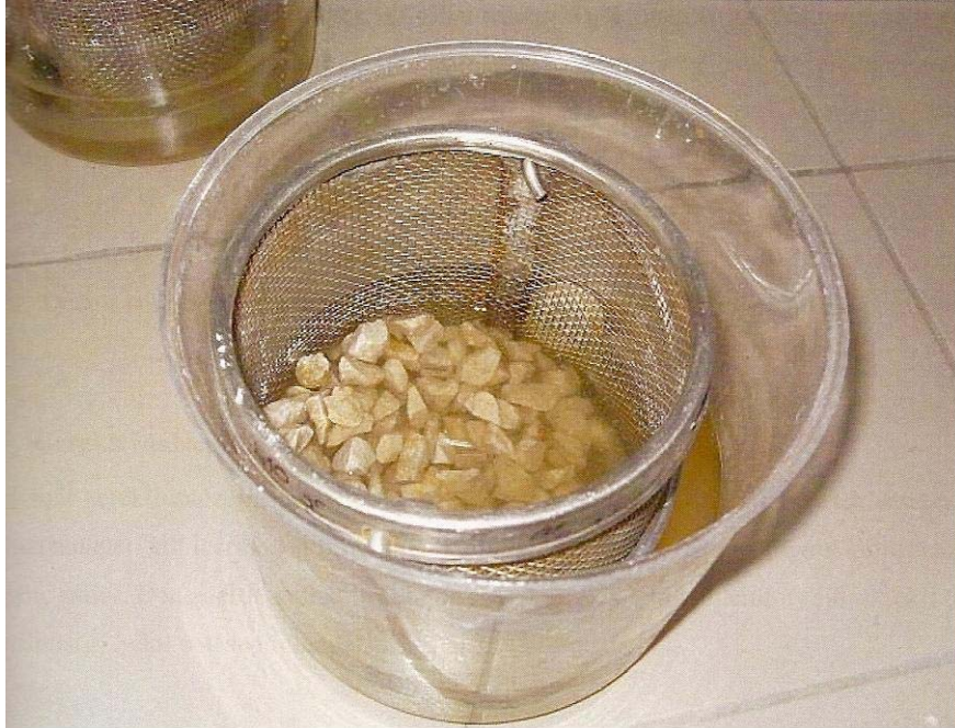
Şekil 6.2 Donma çözünme deney düzeneği
