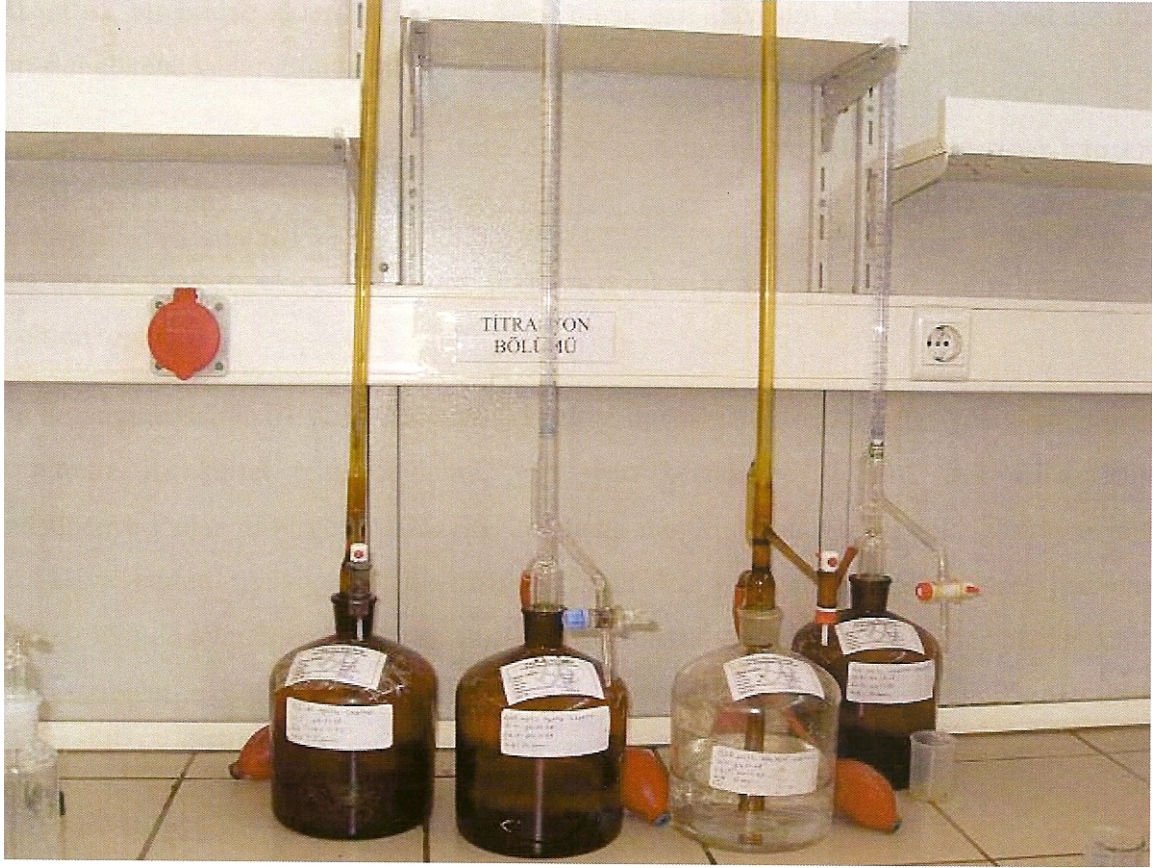
Şekil 6.7 Suda çözünebilir klorür deneyi titrasyon düzeneği
