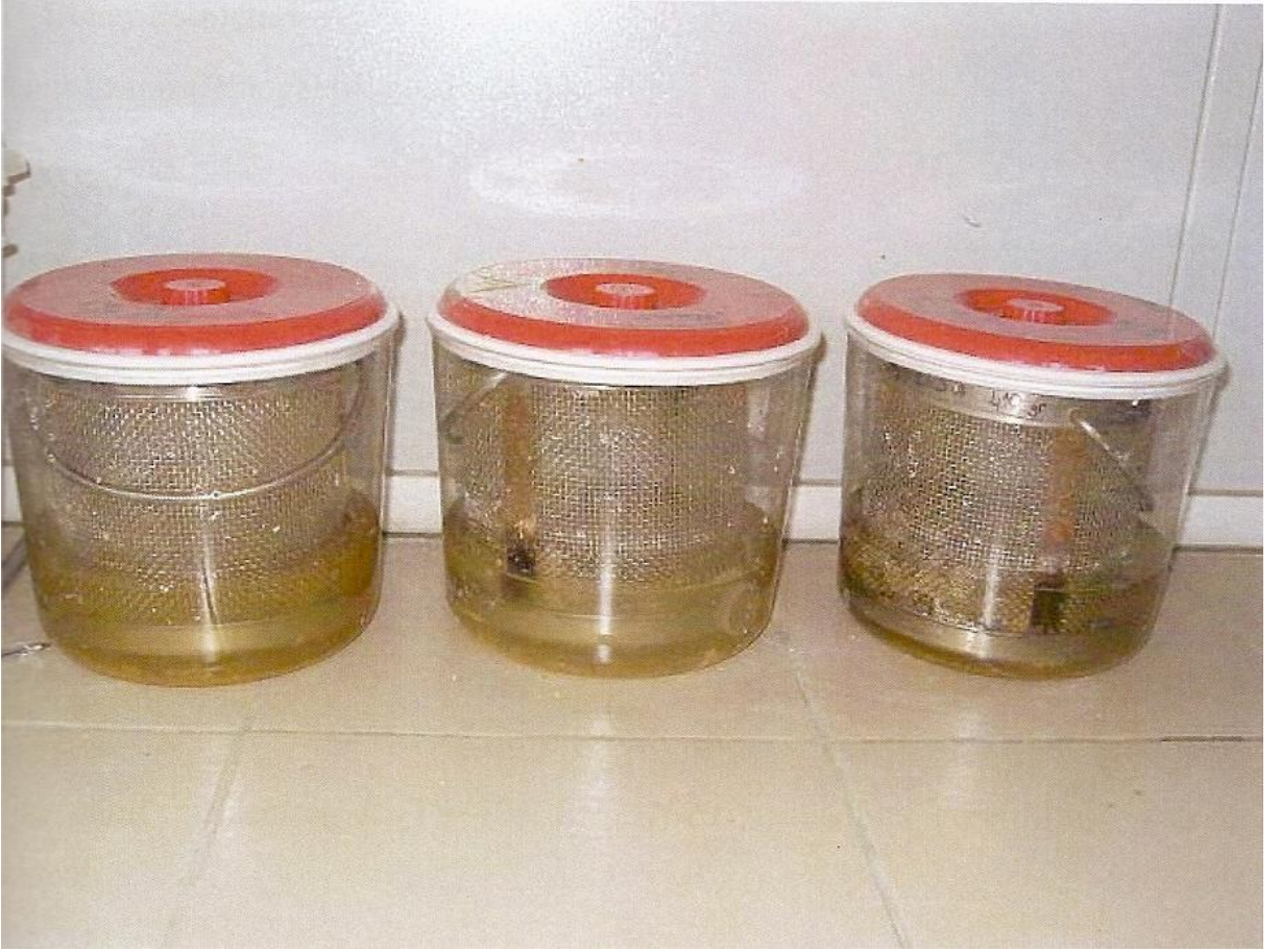
Şekil 6.1 Donma çözünme deneyi paralel deney düzenekleri
