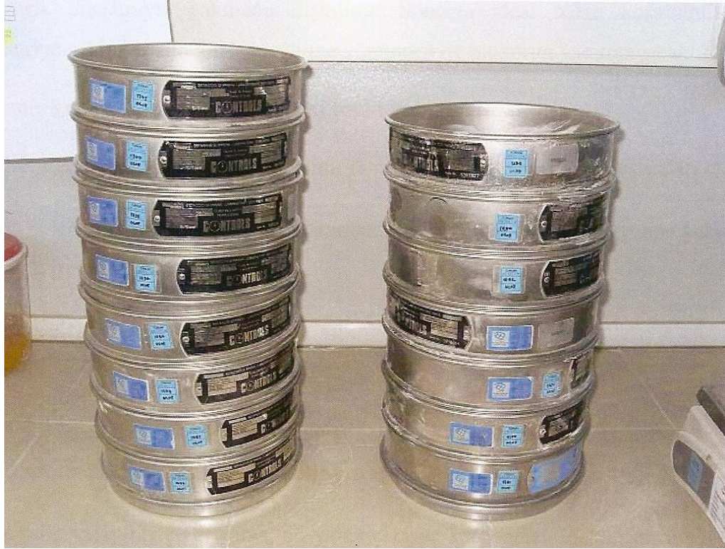
Şekil 6.10 0.25mm ile 31.5mm arası göz açıklıklı elekler
