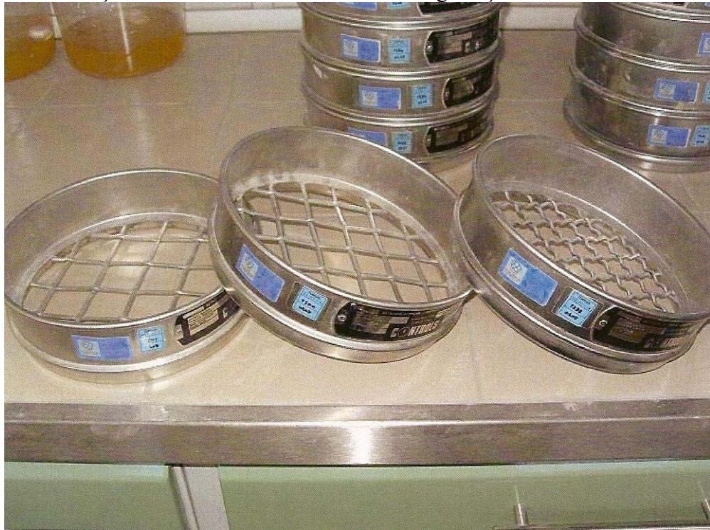
Şekil 6.10 0.25mm ile 31.5mm arası göz açıklıklı elekler
