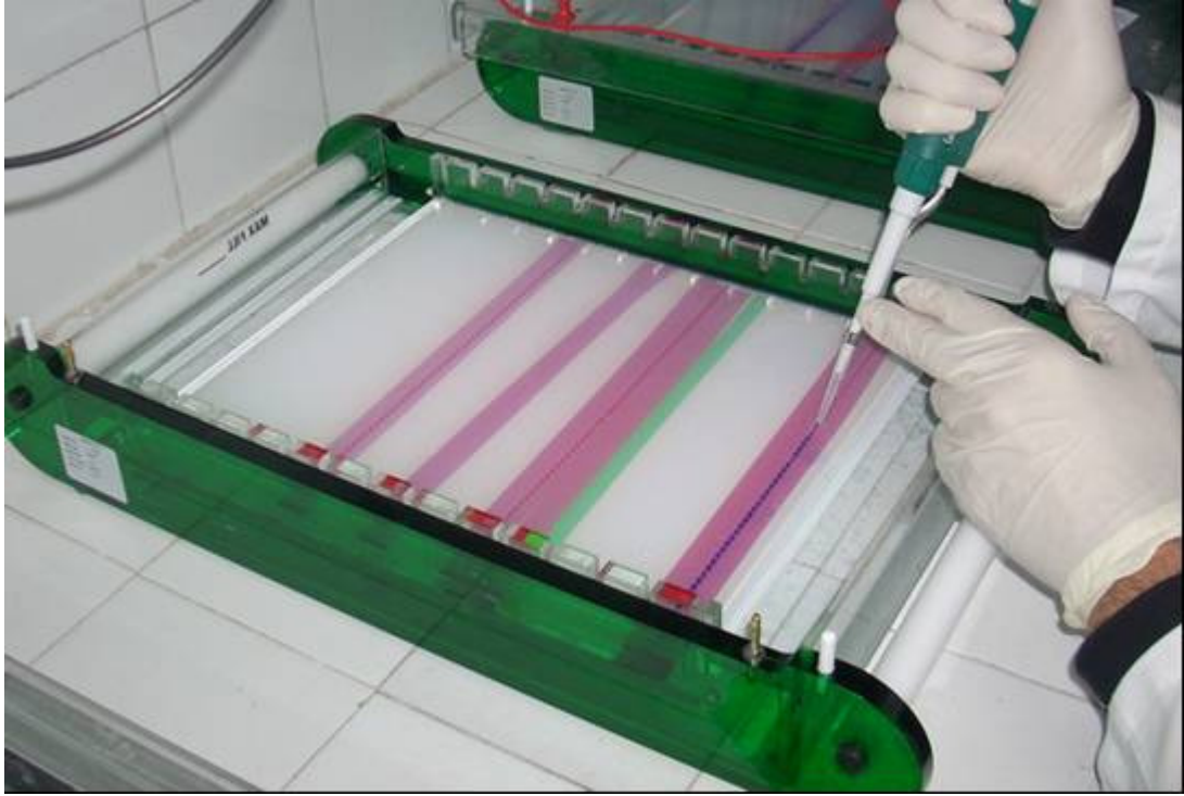
Şekil 3.3. PCR ürünlerinin agaroz jel üzerindeki kuyucuklara yüklenmesi işlemi
