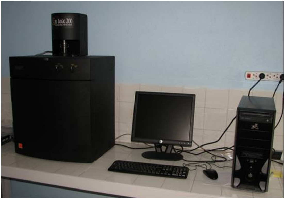
Şekil 3.4. Kodak Gel Logic 200 Jel Görüntüleme Ünitesi
