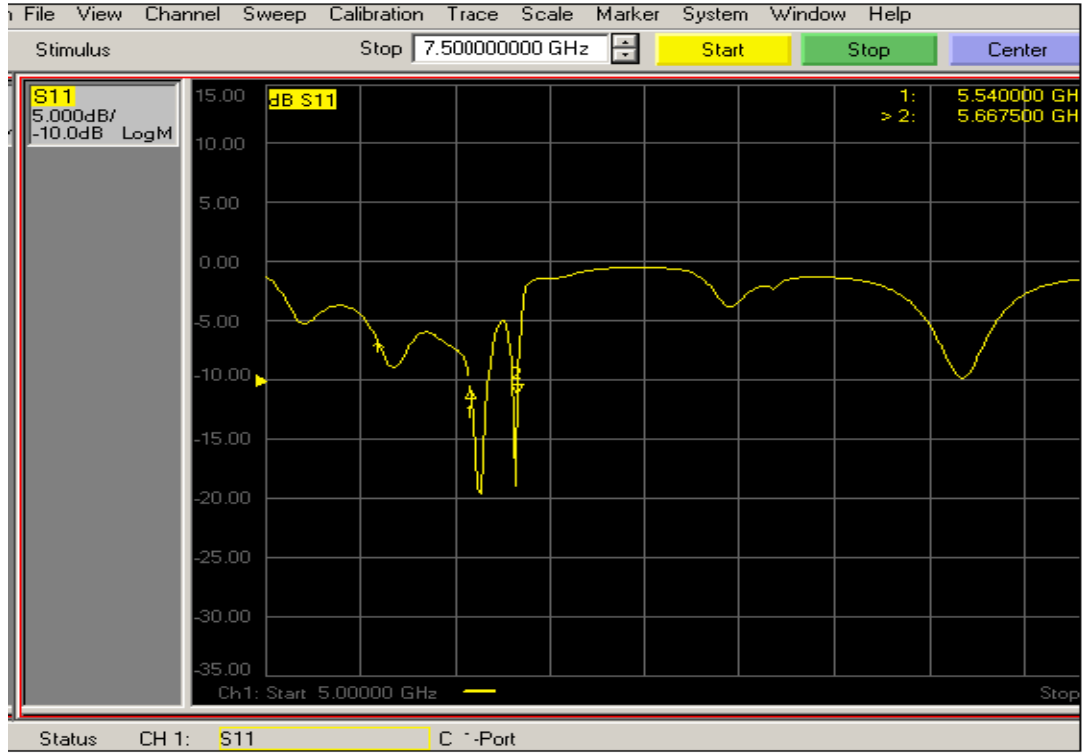
Şekil 4.33. Dikdörtgen dalga kılavuzunun içerisine 10 tane AHR içeren manyetik meta-malzeme yerleştirilmesi durumunda yansıma değerlerinin frekansa göre değişimi
