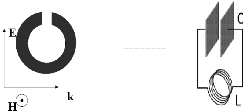
Şekil 4.7. AHR yapı ve elektriksel temsili
