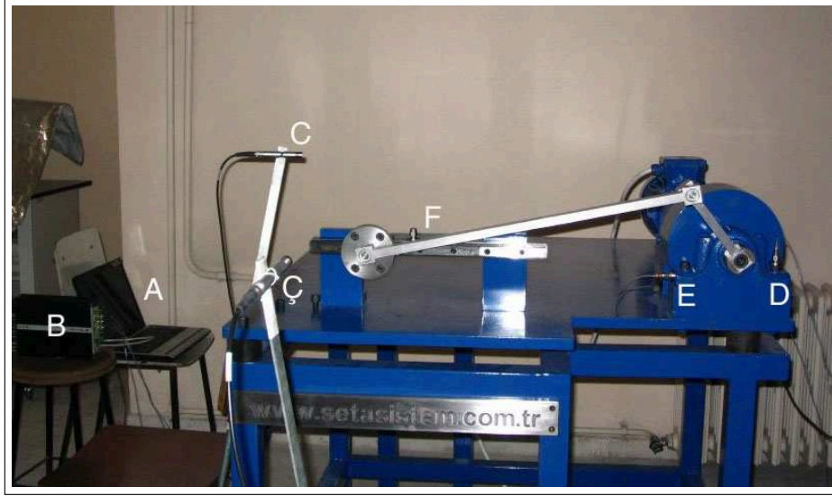
Şekil 5.4. Deneysel sistem üzerinde mikrofon ve ivmeölçer yerleşiminin görünümü
