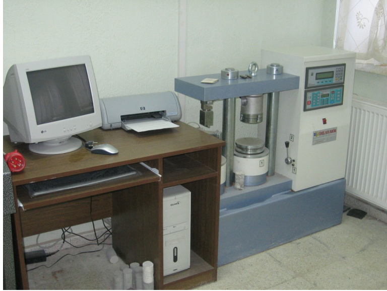
(Şekil 3.4 200 kN'luk bilgisayar kontrollü otomatik basınç presi.
