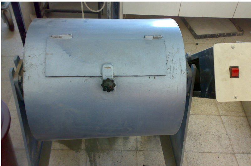
(Şekil 3.2): Cam malzemenin öğütülmesinde ve karışımların homojenize edilmesinde kullanılan bilyeli değirmen.
