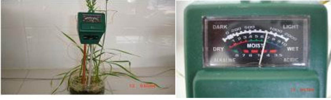
Şekil 3.3. Perlit su miktarını ve pH'sını ölçmede kullanılan TFA COMBI TESTER cihazına ait bir görünüm
