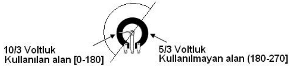
Şekil 3.126 Potansiyometredeki açı sınırlaması
