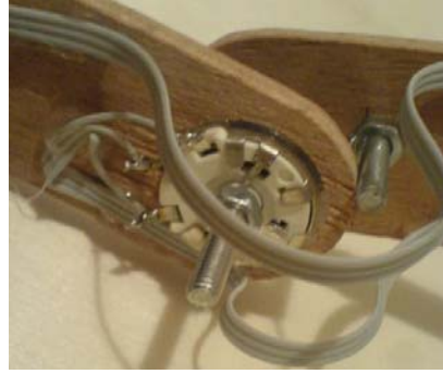
Şekil 3.62 Potansiyometrelerin eklemlere yerleştirilmiş hali
