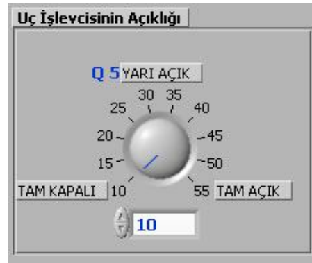
Şekil 3.129 Uç işlevcisi açıklığını kontrol eden potansiyometre
