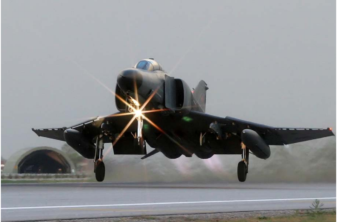
Şekil 5.1. S tekerlek ve iniş takımı düzenine sahip F-4E uçağı [22].
