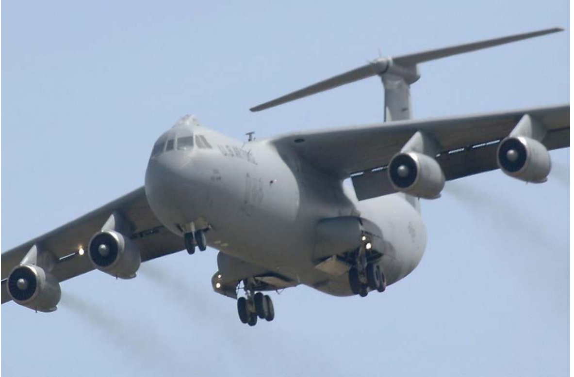
Şekil 5.3. 2D tekerlek ve iniş takımı düzenine sahip C-141 uçağı [24].
