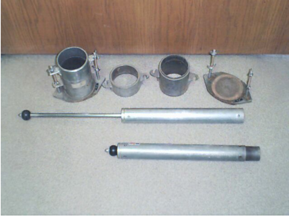
Şekil 2.6. Proktor deney tokmağı ve silindirik metal kalıp
