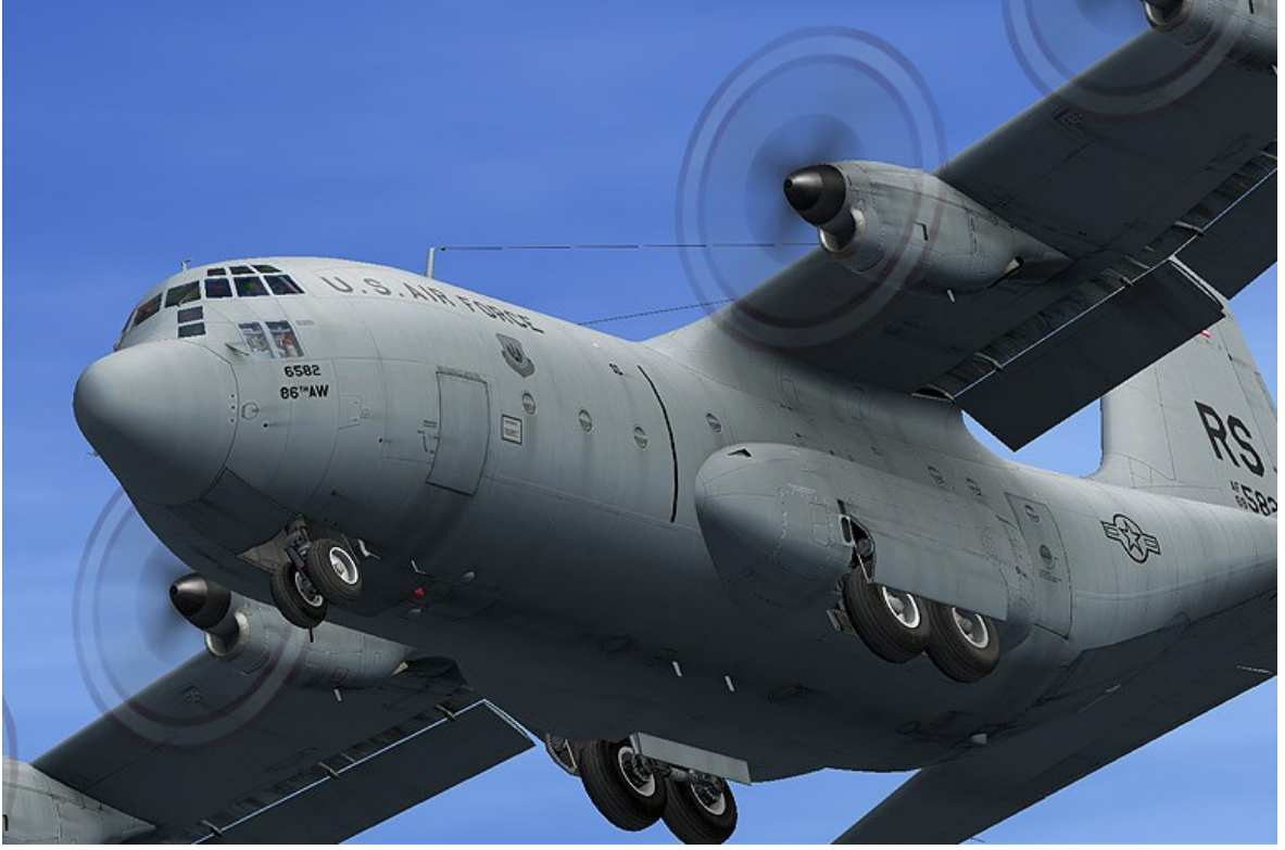
Şekil 5.2. 2S tekerlek ve iniş takımı düzenine sahip C-130 uçağı [23].
