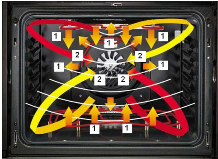
Şekil 1.1 Pişirici içerisindeki doğal (1) ve zorlanmış (2) taşınımına ilişkin şematik görünüm
