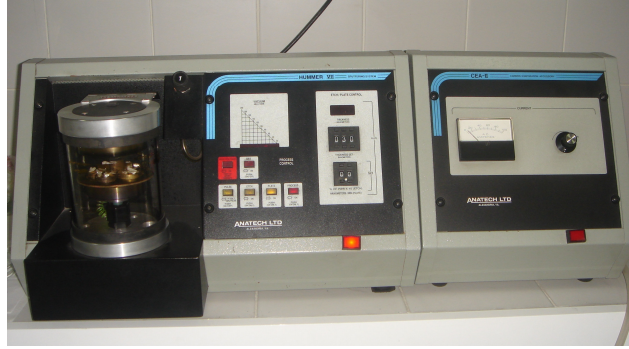
Resim 3.6. Sputter cihazı (Altın-palladyum kaplama cihazı)
