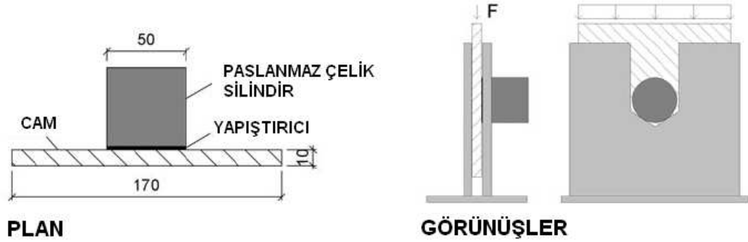
Şekil 6.36 Çelik ve camın yapıştırıcıyla birleştirilmesi.
