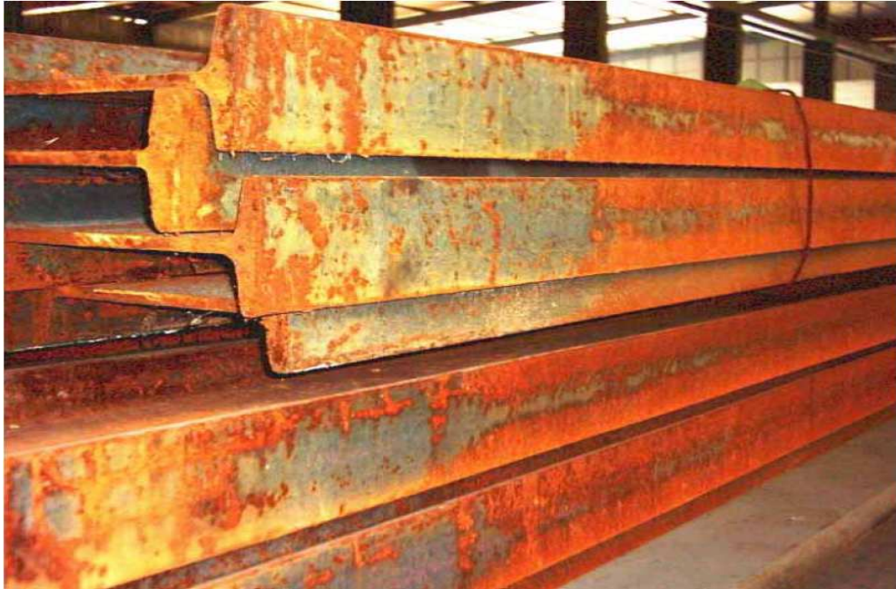
Şekil 3.21 Herhangi bir kaplama yöntemi uygulanmamış ve uygunsuz koşullarda uzun süre depolanmış malzeme üzerinde oluşan pas tabakaları.
