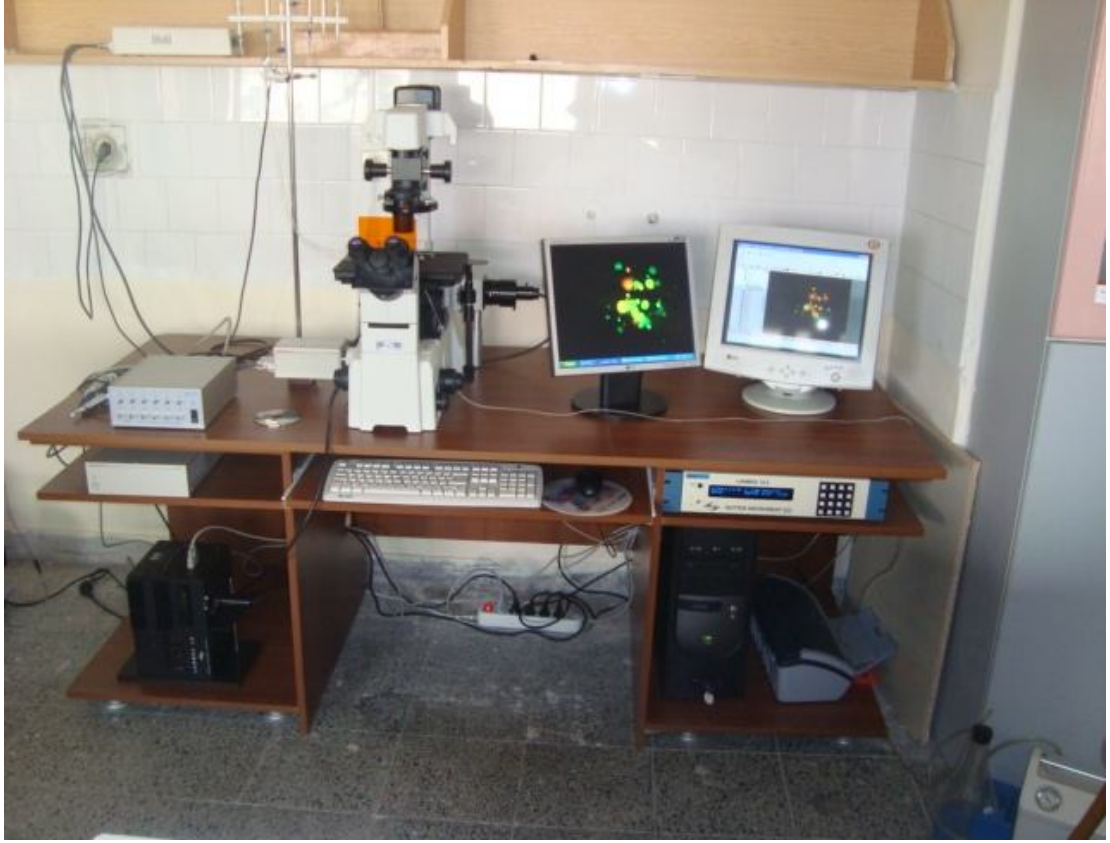
Şekil 6. Flüoresan kalsiyum görüntüleme sisteminin fotoğrafik görünümü. İlaç uygulama/mikroinkübasyon sistemi (sol üst kısım), CCD kamera (sol alt), ters mikroskop ve filtre sürücüsü kontrol ünitesi (sağ).
