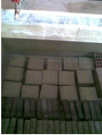
Şekil Ek 2.6. Kür havuzunda bekleyen beton numuneleri.
