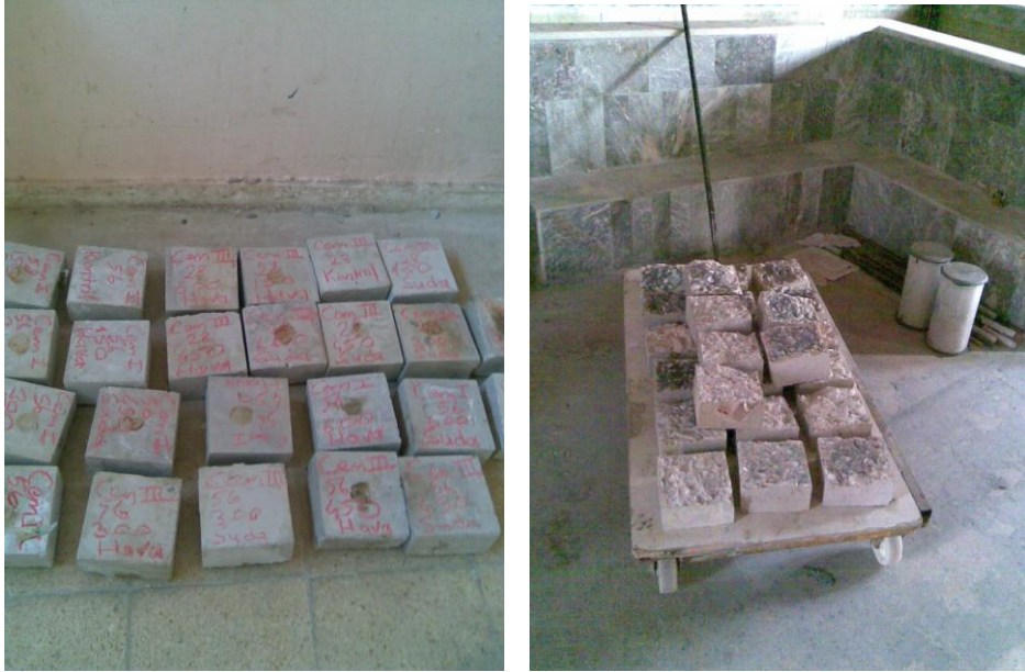
Şekil Ek 2.16. Hacimce su emme deneyi.
