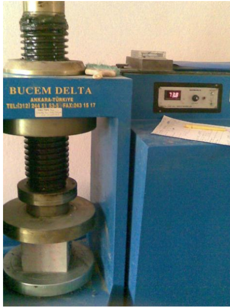
Şekil Ek 2.14. Basınç deneyi.
