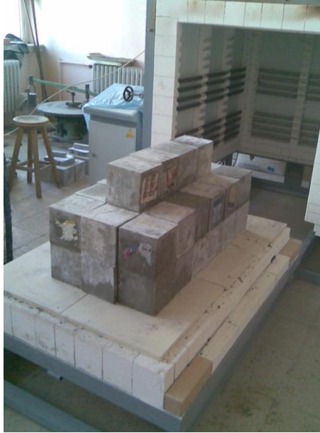
Şekil Ek 2.8. Numunelerin fırına yerleştirilmesi.
