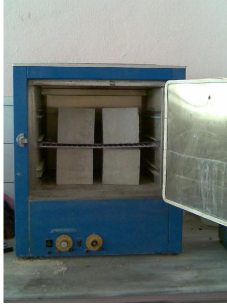
Şekil Ek 2.7. Beton numunelerinin etüvde kurutulması.
