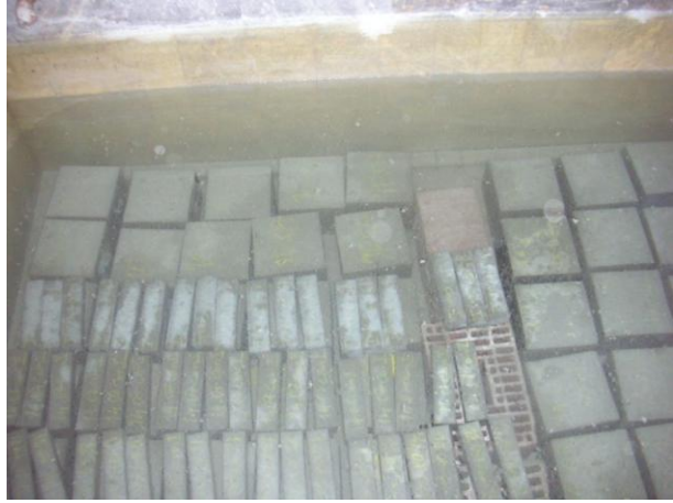
Şekil Ek 2.6. Kür havuzunda bekleyen beton numuneleri.
