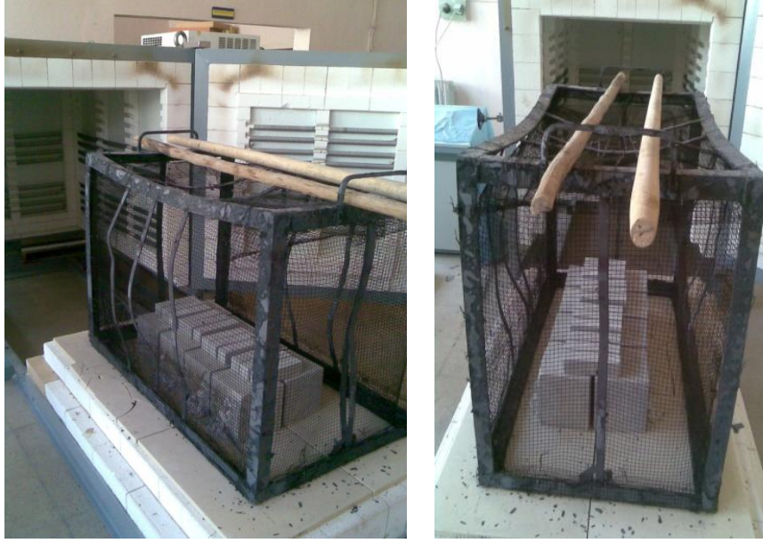
Şekil Ek 2.9. Patlamalara karşı fırını koruyucu tel kafes.
