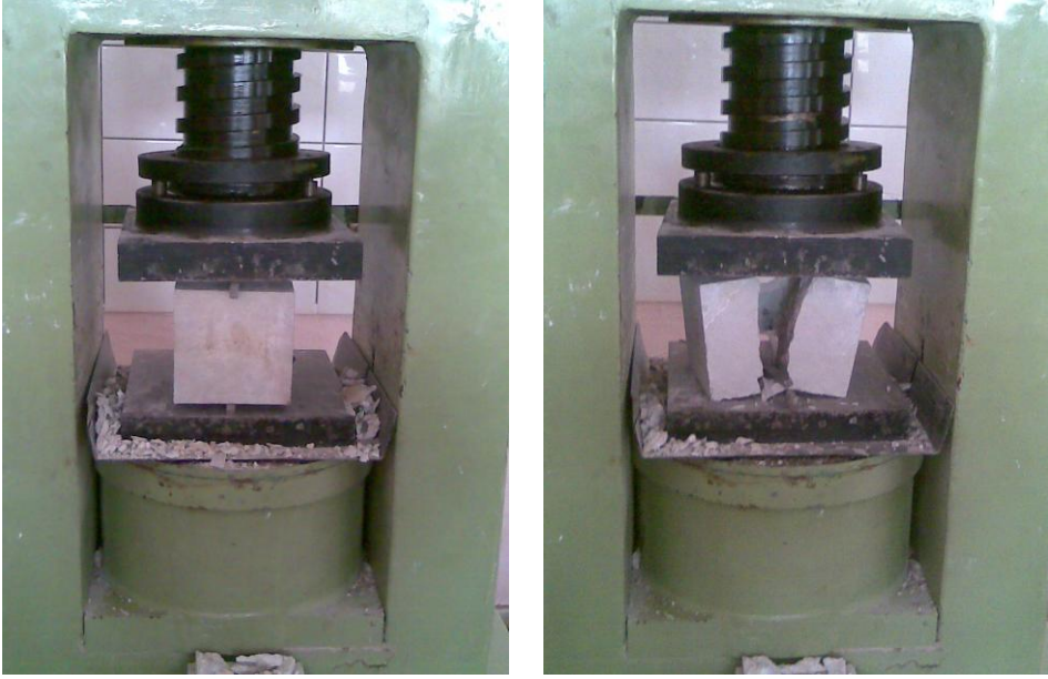
Şekil Ek 2.15. Yarma deneyi.
