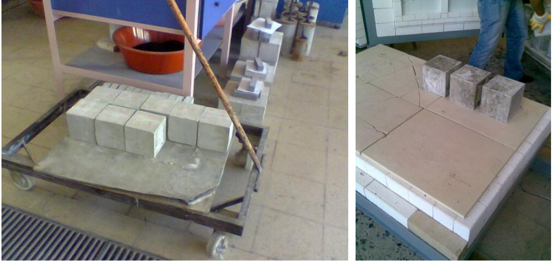
Şekil Ek 2.10. Yüksek sıcaklık sonrası havada soğumaya bırakılan beton numuneler.
