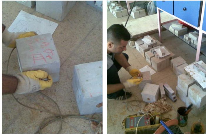
Şekil Ek 2.12. Ultrases geçiş deneyi.
