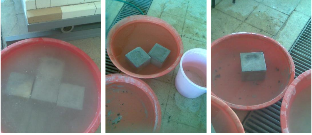
Şekil Ek 2.11. Yüksek sıcaklık sonrası suda soğumaya bırakılan beton numuneler.
