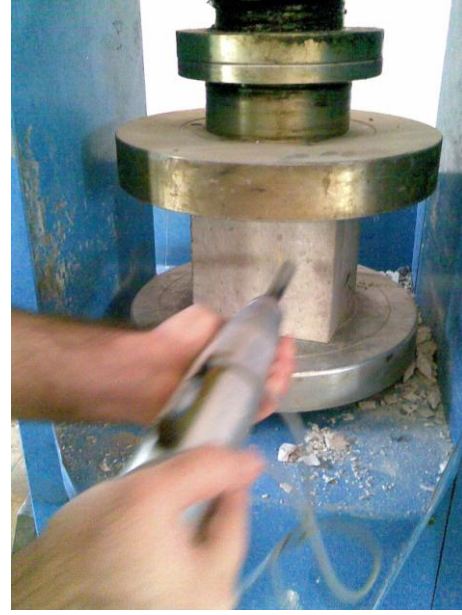
Şekil Ek 2.13. Yüzey sertliğinin belirlenmesi.
