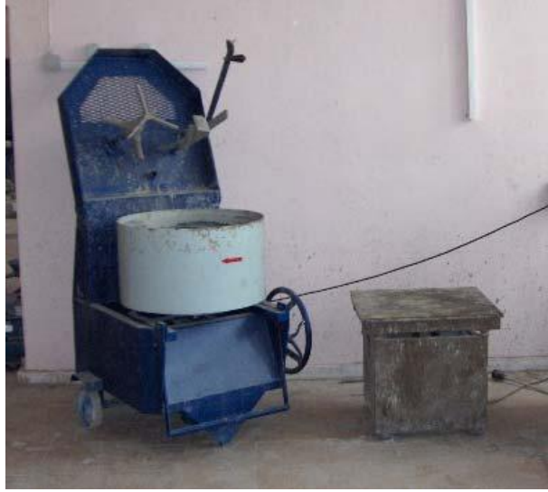
Şekil Ek 2.4. Beton mikseri ve vibratör masası
