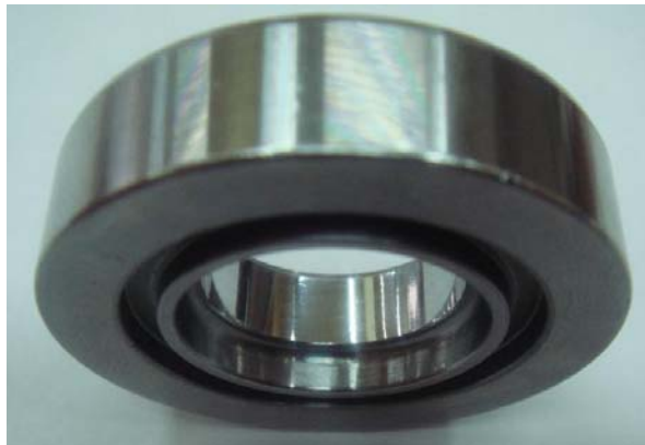
Şekil 6.4 Makaralı perdahlama sonrası oluşan yüzey
