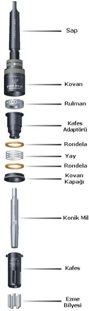
Şekil 3.1 Makaralı perdahlama takımının elemanları (Yamasa, 2008)
