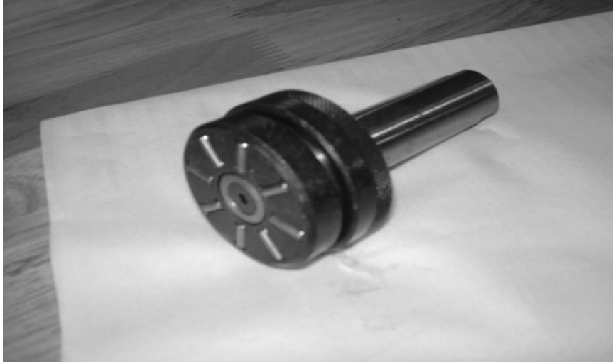
Şekil 8.13 Çalışmada kullanılan perdahlama takımı (Thamizhmanii vd., 2007)
