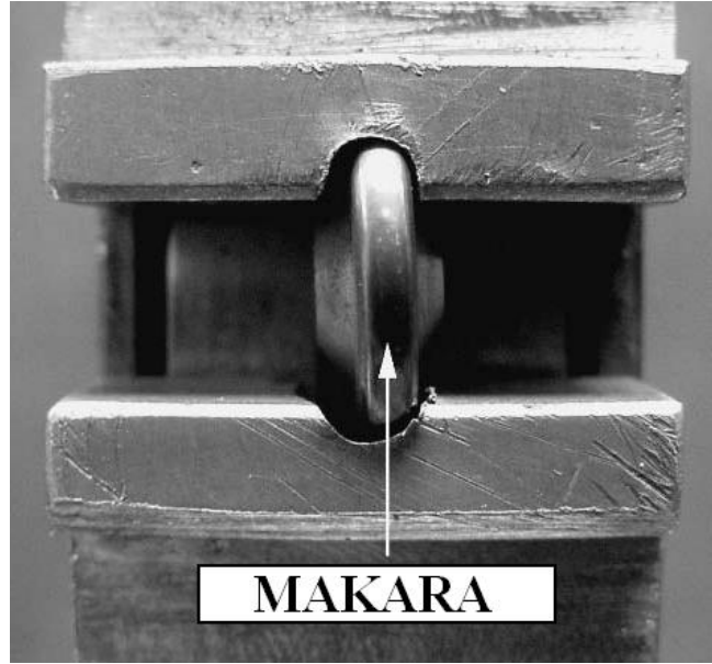
Şekil 6.8 Çalışmada kullanılan tek makaralı perdahlama takımı (Maluf vd., 2004)
