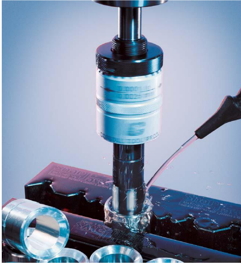
Şekil 4.3 Manuel bir matkap tezgahında makaralı perdahlama örneği
