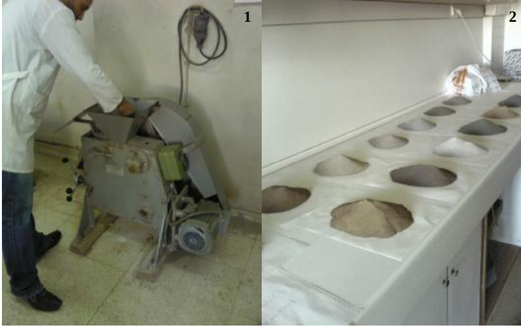
Foto 5.5. Örneklerin kırılması ve öğütülmesi işlemi (1-Kırma, 2- Öğütme)
