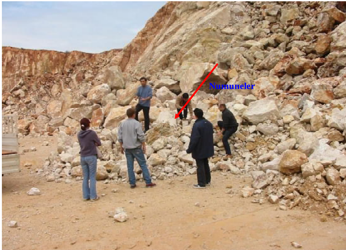
Foto 5.2. Sistematik örnek alımı (Ceyhan Yöresi Kireçtaşı Ocağı)
