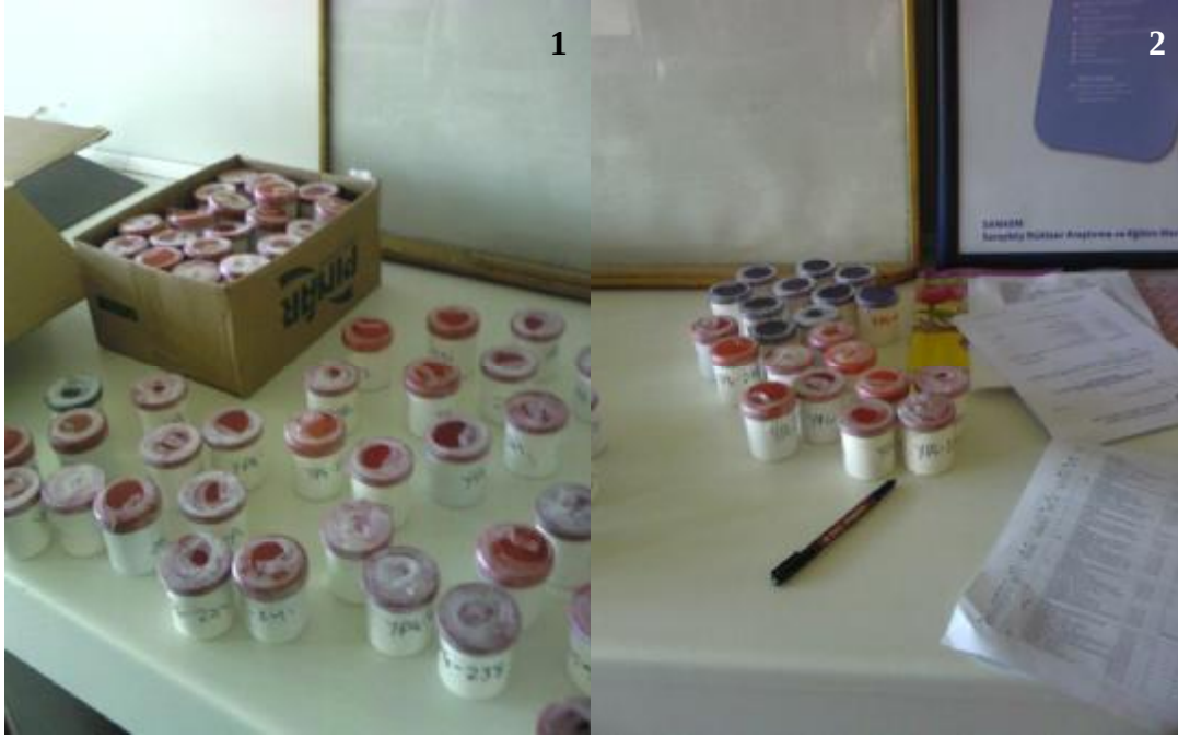
Foto 5.7. Örneklerin analiz kaplarına alınışı (marinelli kaplarında kataloglama)
