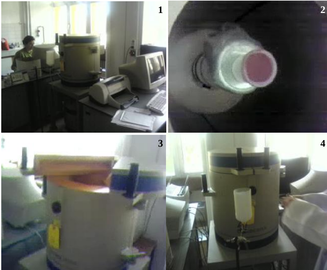
Foto 5.8. Canberra Model 767 gamma spektrometre cihazı (1-2-3-4)
