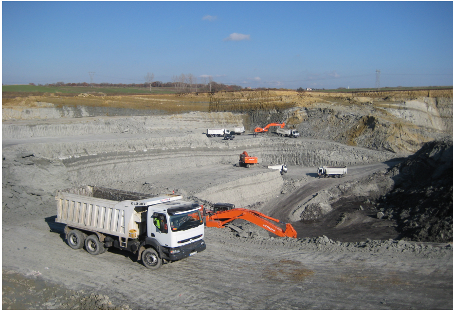
Şekil 4.1. İşletmede Dekapajda Çalışan Kamyon ve Makinaların Görünüşü
