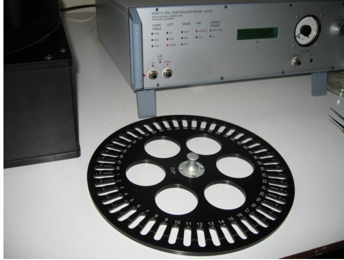
Şekil 6.6. Aynı anda 48 örneğin okunmasını sağlayan döner levha
