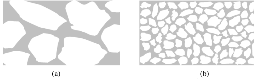
Şekil 2.30 Agregatane boyutu hamur hacmi ihtiyacı ilişkisi; a) İri agregalı sistem için kesitteki çimento hamuru oranı %30,9, b) Mikro agregalı sistem için %31,9.
