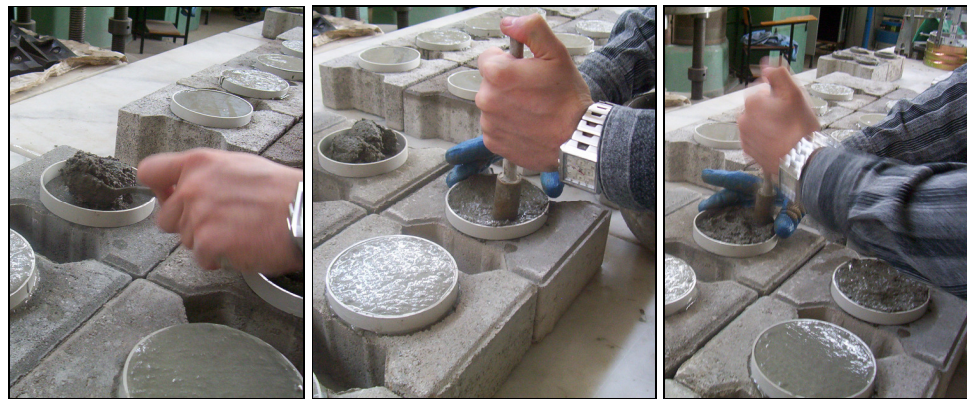
Şekil 5.6 Standart harç karışımlarında uygulanan sıkıştırma işlemi.
