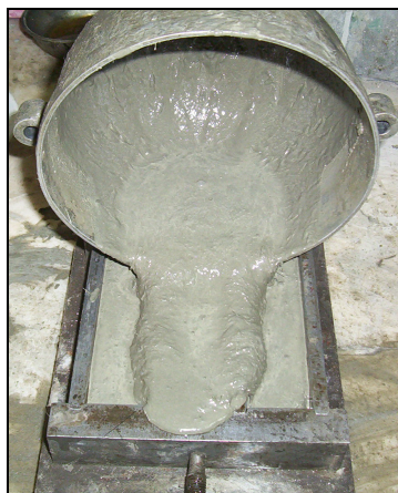
Şekil 4.9 Kendiliğinden yerleşen kıvamdaki matrisin kalıba yerleşimi (PVA rf400).
