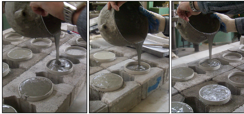
Şekil 5.5 Lifli MB’lerin kalıba dökümü.
