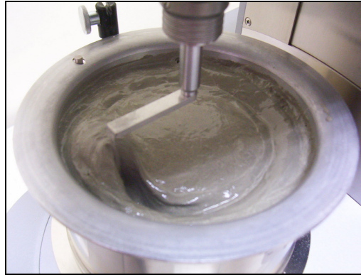
Şekil 3.60 Bilye %2 PVA katkılı karışım içinde dönerken ön kısımda lif kümelenmesinin yarattığı yükselme.
