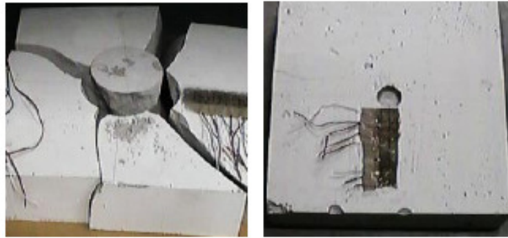
Şekil 2.17 Lifsiz döşemde ve PVA lifli mikro beton (ECC) döşemde zımbalama etkisi sonrası yüzey görünümü (Li ve Kanda, 1998).
