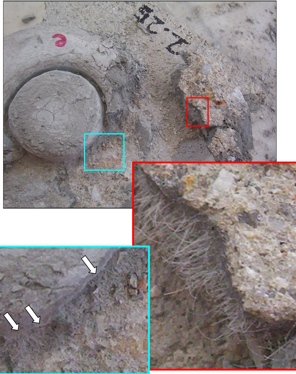
Şekil 5.18 Liflerin çekme koparma performansını artırıcı etkisi.
