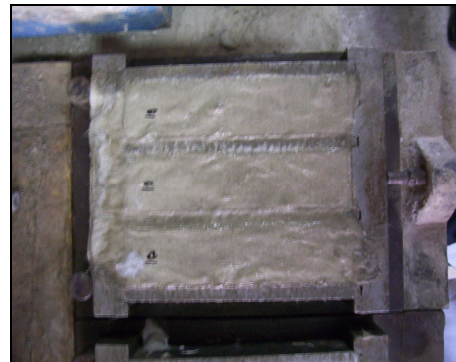
Şekil 4.10 PP lifin yüksek oranda kullanılması (%2) halinde perdah yüzeyi.
