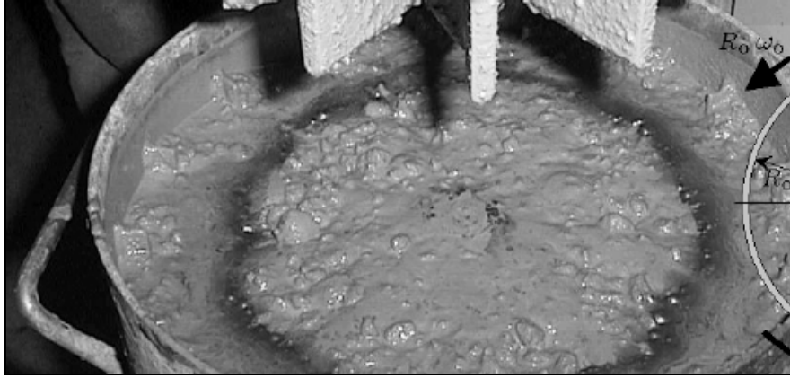
Şekil 3.57 İri agrega içeren ve yüksek S/Ç oranında hazırlanan betonun ölçüm sırasında ayrışması (Wallevik, 2003).
