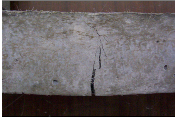
Şekil 4.19 MII matrisinde rec15 lifinin %1 oranında kullanıldığı örnek.
