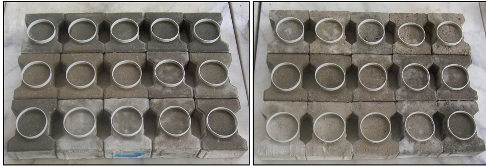
Şekil 5.4 Kilit taşı üzerine uygulanacak karışımlar için kalıp.
