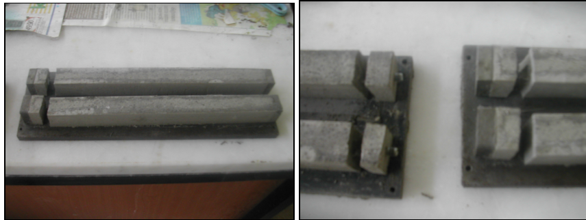
Şekli 6.48 Lifsiz mikro beton örneklerin en dar kesitlerinden çatlaması.
