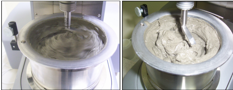
Şekil 3.61 %2 PP katkılı karışım içinde bilye hareketinin harçta yarattığı dalgalanma.
