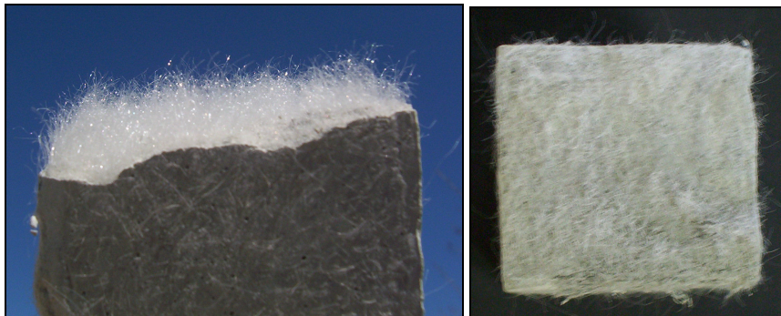
Şekil 4.23 PP liflerin MI matrisinde homojen lif dağılımı (%2).
