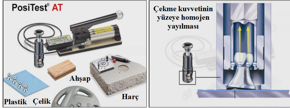
Şekil 5.10 Positest çekme koparma test cihazı ve engeli yüzeylerde üniform yük dağılımını sağlayan bilyeli sistem.
