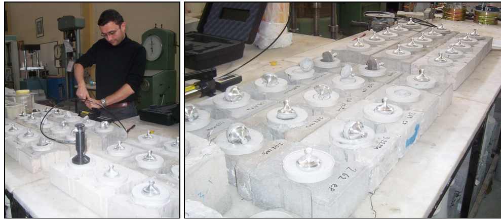
Şekil 5.11 Çekme koparma testlerinin yapılışı.
