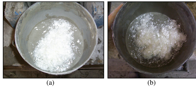
Şekil 4.7 Liflerin matrise ilavesi (a: %2 PP, b: %2 PVA (rec7)).
