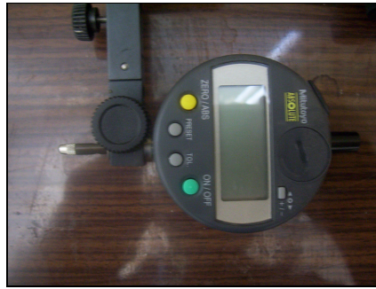
Şekil 6.9 Mitutoyo Digimatic 543-254B tipi komparatör.
