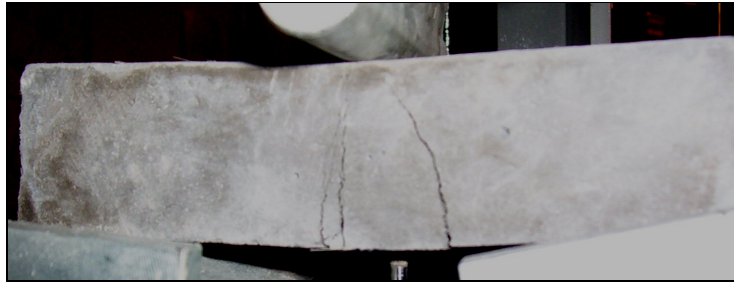
Şekil 4.21 %2 recs100 lifi içeren MIII matrisinin çatlak fotoğrafı.
