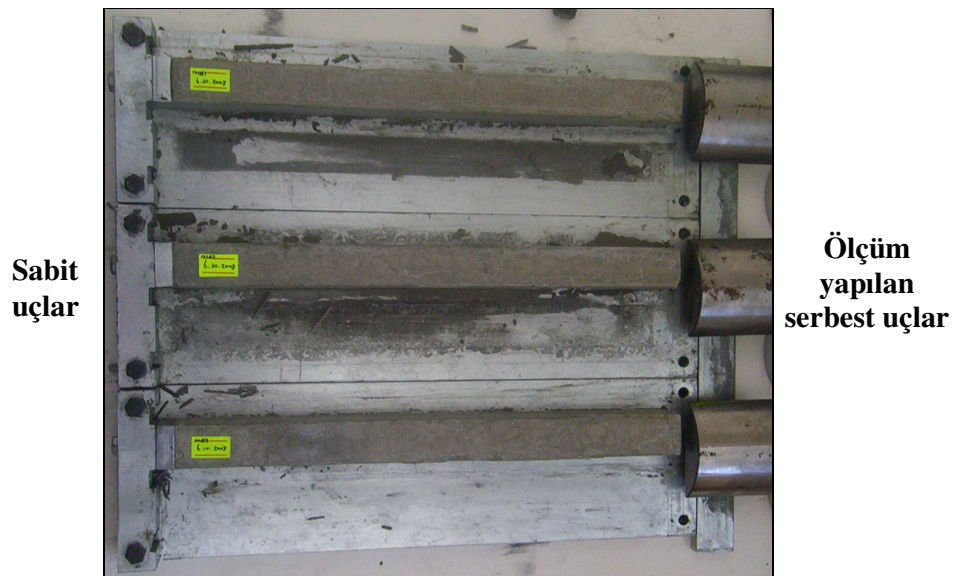
Şekil 6.19 Uç ve yan kalıpları açılmış yarı ankastre örnekler (ölçüm sırasında üstten görünüm).
