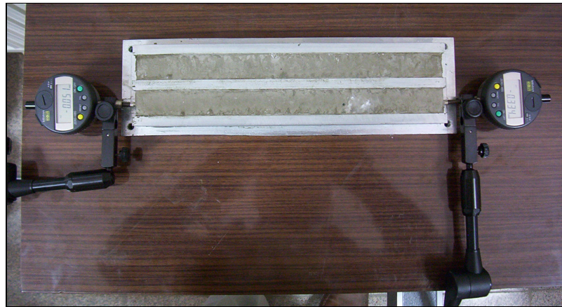
Şekil 6.10 Aksenal olarak taze örnek enkesit merkezine sabitlenen komparatörler.
