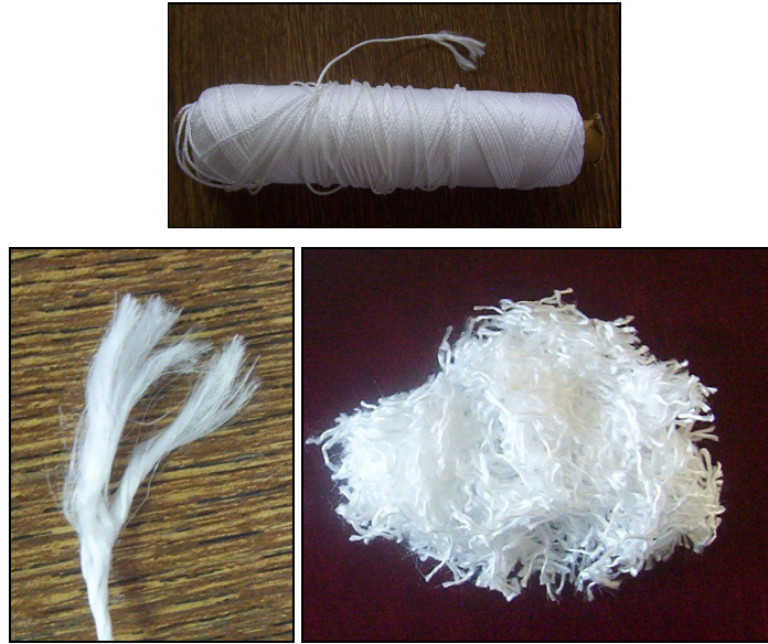
Şekil 4.5 YYPE (Dyneema®SK75) ipliğin lif haline getirilmesi.
