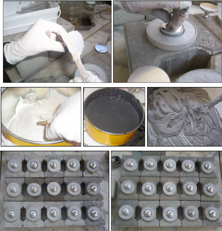
Şekil 5.9 İki bileşenli Epoksi yapıştırıcı ile alüminyum piyonların yapıştırılması.
