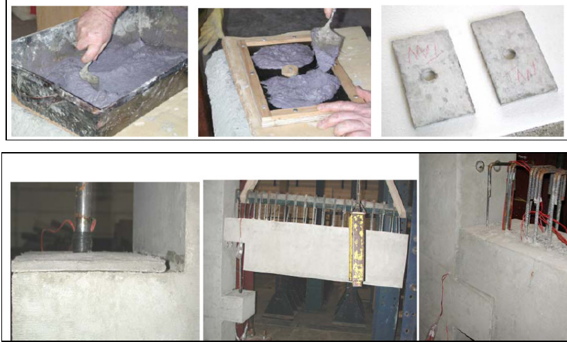
Şekil 2.16 Elastomer mesnet yastıklarına alternatif olabilecek lifli mikro beton mesnet yastıkları (Barboza ve diğer., 2002).
