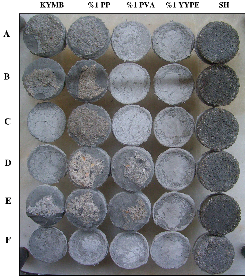
Şekil 5.15 Çekme koparma deneyi sonrasında piyon kopma yüzeyleri.
