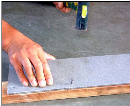
Şekil 2.18 Lifli mikro beton plakalara çivi çakılabilir (Ogawa ve diğer., 2005).
