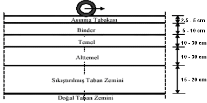
Şekil 2.2 Karayolu üst yapısını oluşturan tabakalar ve kalınlıkları (Terzi 2000).
