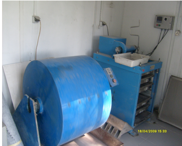
Şekil 5.16 Los Angeles deney aleti.
