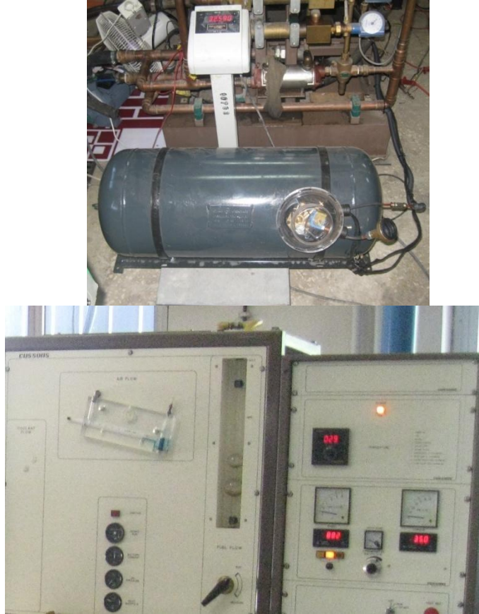
Şekil 7.8 LPG ve Benzin için yakıt tüketim miktarlarının belirlenmesinde kullanılan düzenekler
