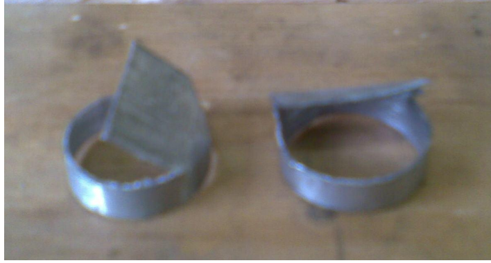
Şekil 7.18 Emme kanallarına yerleştirilen karışım yönlendiricileri
