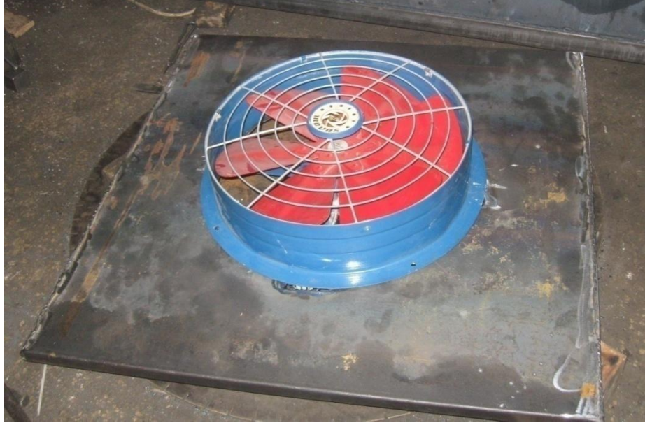
Şekil 7.3 Soğutma kulesi hava emiş fanı imalat görüntüsü
