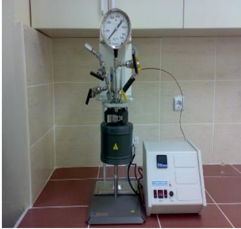
Şekil 3.1. Gazlaştırmada kullanılacak yüksek basınç reaktörü
