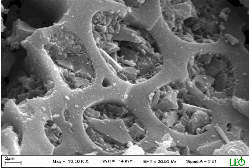
Şekil 4.5. %5 Pd (aktif karbon) katalizörünün deney öncesi SEM görüntüsü
