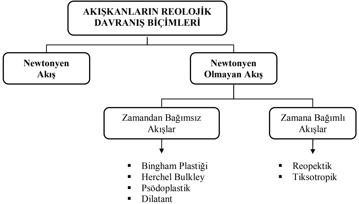
Şekil 4.4 Akışkanların reolojik davranış biçimlerinin sınıflandırılması (Ak, 1997)
