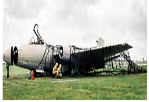
Şekil 1.2. Ağ Bariyer Yakalama Sistemi.
