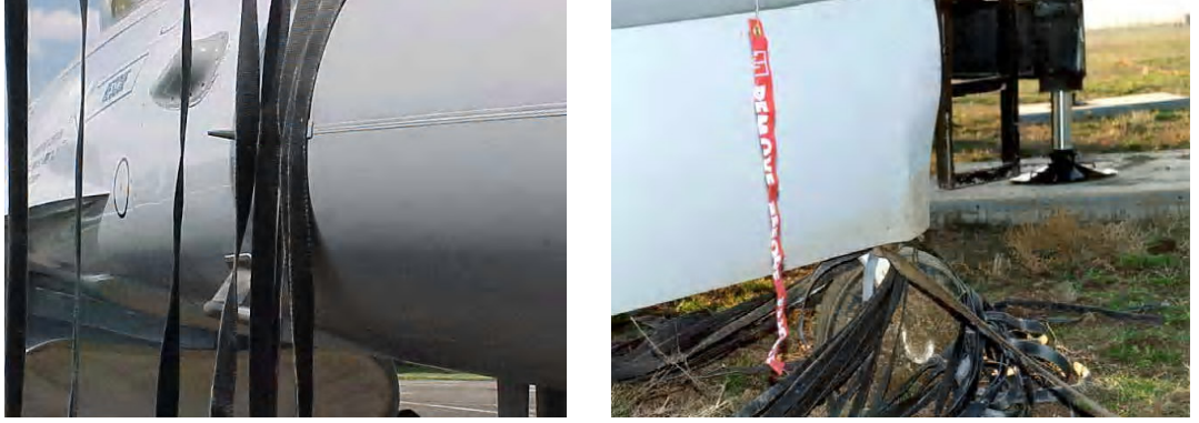
Şekil 2-6 Prop Üzerindeki Ağ Şeritleri ve Hasarlanmış Teker Kapağı
