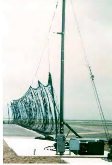
Şekil 2-2 Çok Elemanlı Ağa Sahip Ağ Bariyer Yakalama Sistemi
