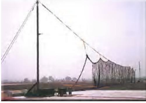
Şekil 1.2. Ağ Bariyer Yakalama Sistemi.
