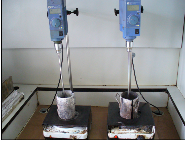
Şekil 3.9 Numunelerin ısıtılıp karıştırılarak hazırlanması
