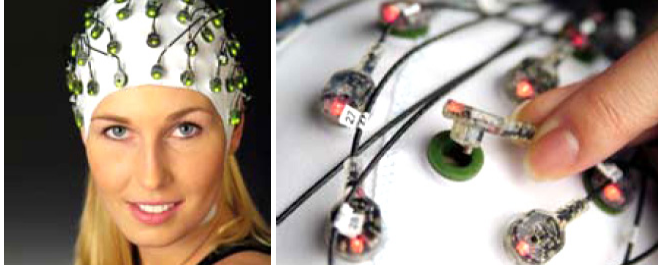
Şekil 3.2: EEG kaydı için kullanılan kep ve aktif elektrotlar.
