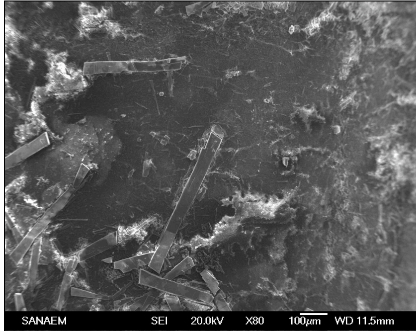
Şekil 3.3.B. Fosfomisin yüklü PLGA ve PEG kaplı stent yüzeyinde oluşan taşlaşmanın taramalı elektron mikroskop görüntüsü.
