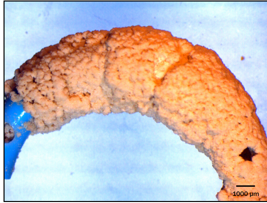
Şekil 3.6.C. 12.Hafta fosfomisin yüklü PLGA ve 30dk PEG kaplı stentin optik mikroskop görüntüsü.
