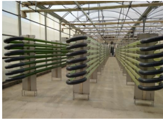
Şekil 2.3. Tubuler/borulu fotobiyoreaktör (Jacob-Lopes et al., 2020a)
