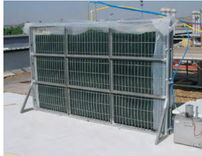
Şekil 2.2. Düz Panel Fotobiyoreaktör (Sevilla, İspanya) (Posten and Walter, 2012)
