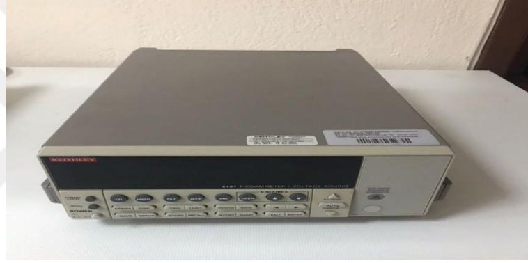
Şekil 4.7. Keithley 2400 Ampermetre (Süleyman Demirel Üniversitesi Fen Edebiyat Fakültesi Fizik Bölümü Yarıiletken Laboratuvarı)
