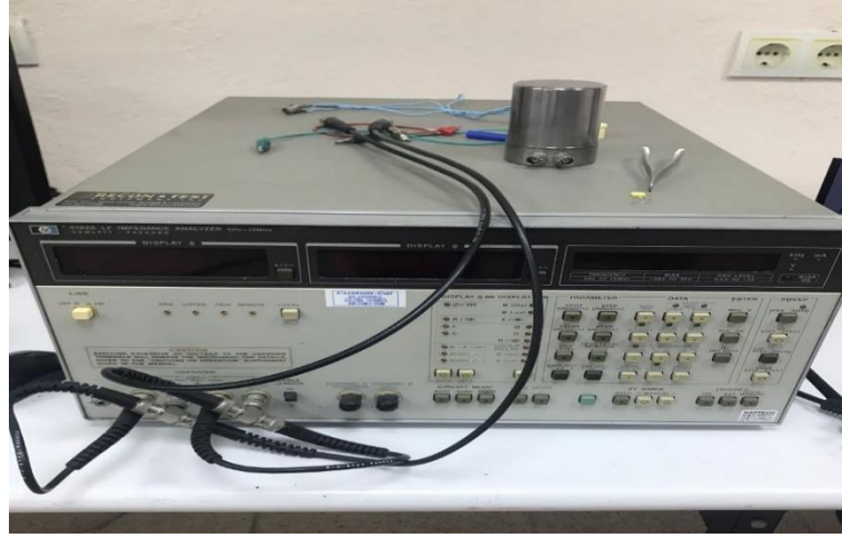
Şekil 4.6. HP-4192A Impedance metre (Süleyman Demirel Üniversitesi Fen Edebiyat Fakültesi Fizik Bölümü Yarıiletken Laboratuvarı)
