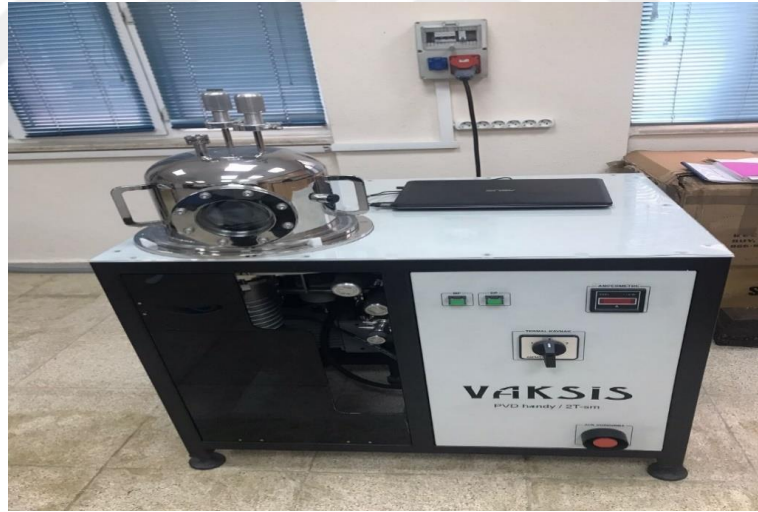
Şekil 4.5. Vaksis PVD Handy Saçtırma Magnetron Kaynağı (Süleyman Demirel Üniversitesi Fen Edebiyat Fakültesi Fizik Bölümü Yarıiletken Laboratuvarı)
