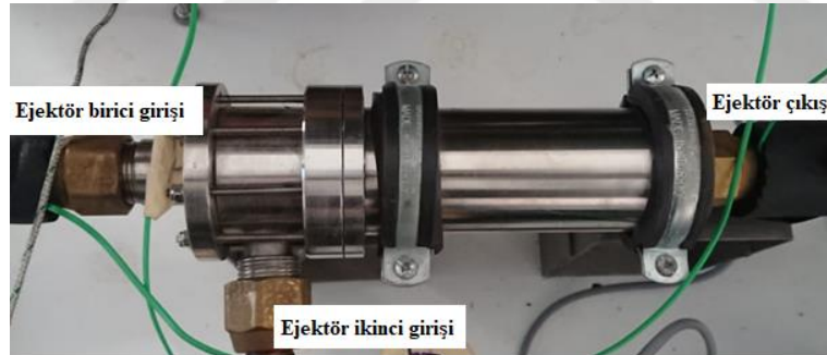
Şekil 2.5. Deneysel sistemde kullanılan ejektör
