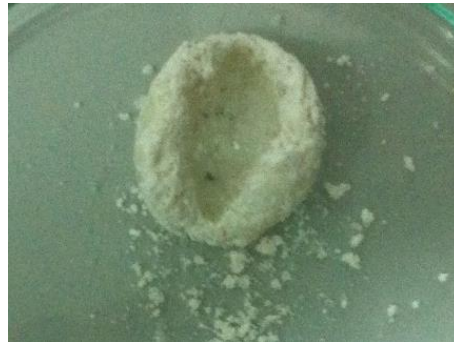
Şekil 7.19 Jel yüzeyinde kalıntı olarak H_3BO_3 kalan numunenin, 120 °C’de 24 sa. süre ile kurutulması sonrasındaki makro görüntüsü
