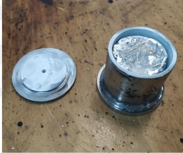
Şekil 5.10 Kalıba yerleştirilmiş mastır kompozit
