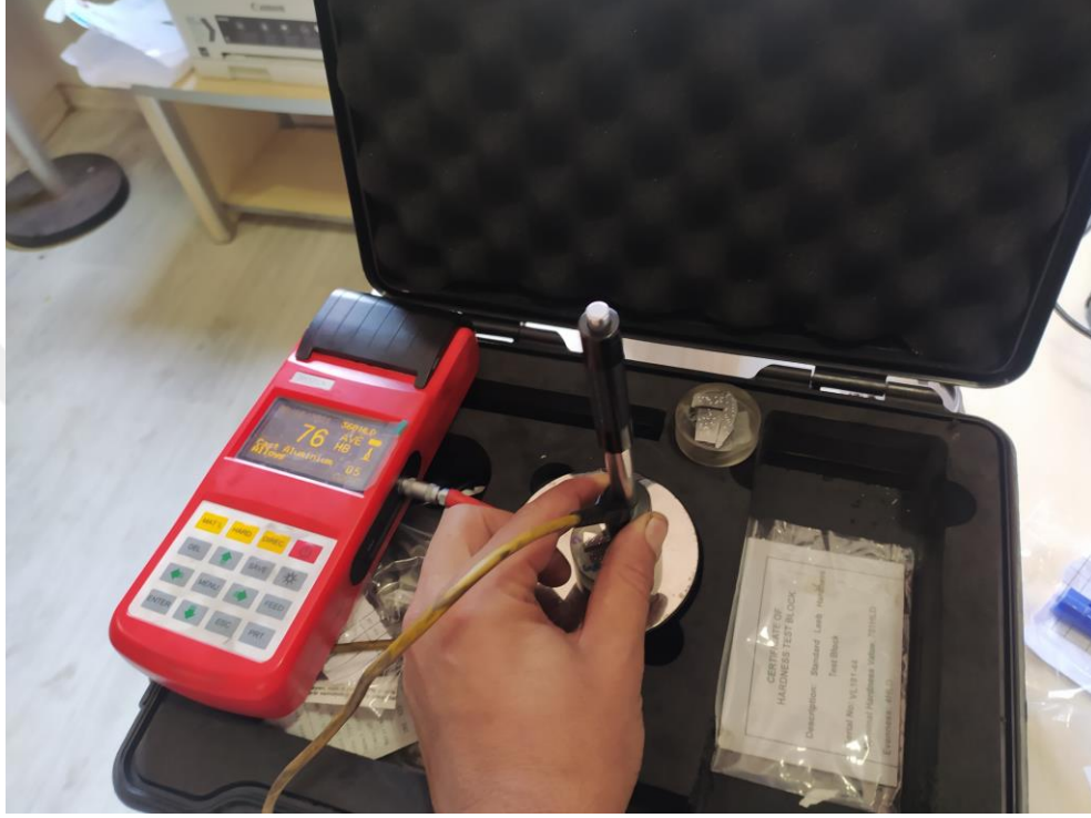
Şekil 5.16 THL 500 Sertlik Ölçüm Cihazı Kullanılarak Numunlerden Sertlik Ölçümü Alınması
