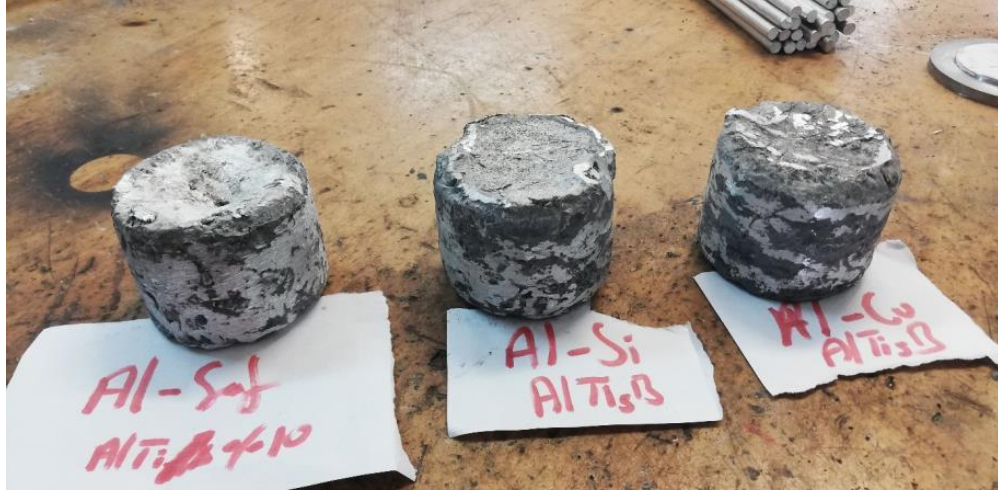
Şekil 5.6 %5 oranında TiB 2 içeren saf Al, Al-%4Si ve Al-%4Cu matrisli mastır kompozitlerin görüntüsü
