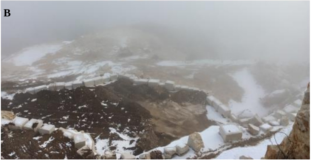
Şekil 4.61. Kademe kenarlarına güvenlik açısından ekonomik değerini yitirmiş blokların dizilmesi (A) ve kademe diplerine toprak dolgu serilerek ağaçlandırmaya hazır hale getirilmesi (B) (Akpınar güneyi)
