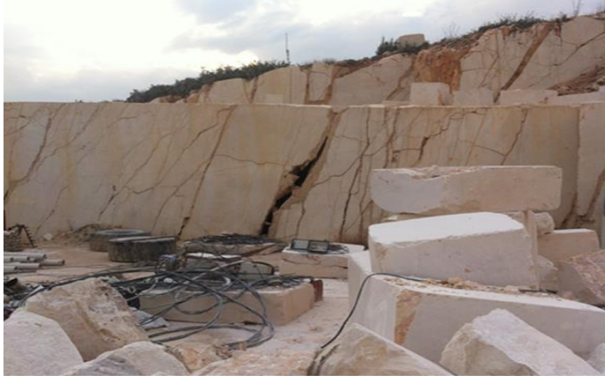
Şekil 4.13. Dutttere kireçtařlarında açılan fakat yoğun kırık, çatlak ve renk karışımıları nedeniyle faaliyeti durdurulan bir ocaktan görünüm (Yılmaz, 2017)
