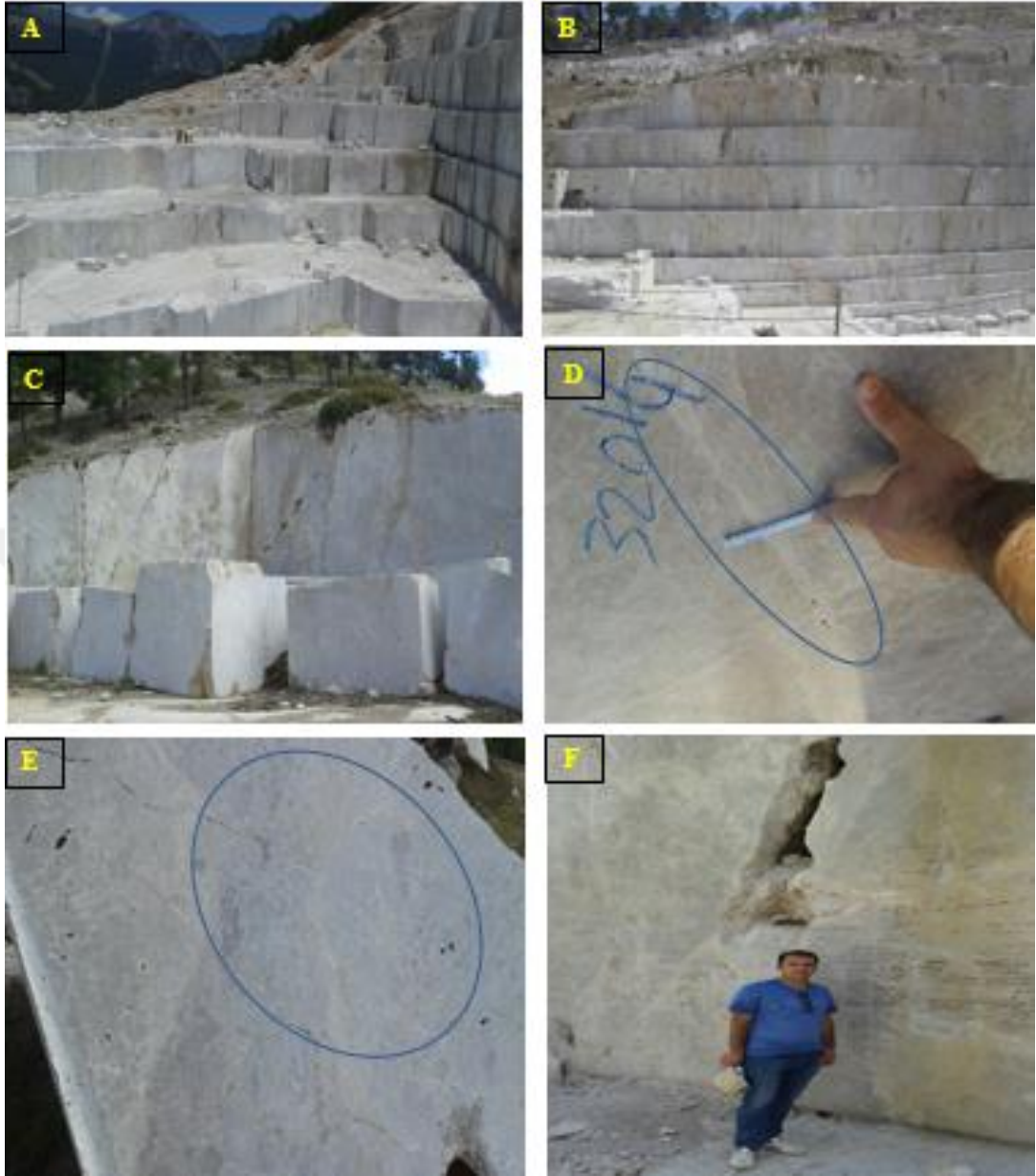
Şekil 4.25. Tekedağ formasyonu dolomit seviyelerinden ticari mermer üretimi yapılan ocaklardan görünüm (A: Aşağıgökdere, B: Aşağıgökdere kuzeyi, C: Aşağıgökdere güneyi, D: üretilen bloklarda olumsuzluk oluşturan kumlu yapı, E: homojenliği bozan girdiler, F: ocak kademelerinde görülen karstik boşluklar)
