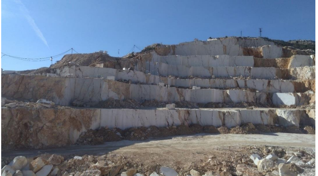
Şekil 4.60. Büyükgökçeli güneybatısında bulunan, etkisiz atıklar ve pasanın ocak tabanından başlanılarak kademe diplerine serilmesi yöntemiyle çevre ile uyum çalışmaları yapılan bir ocak alanı
