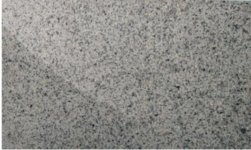
Şekil 4.58. Ticari mermer olarak üretilen fonolitlerin plaka görünümü (İSTEM, 2021)
