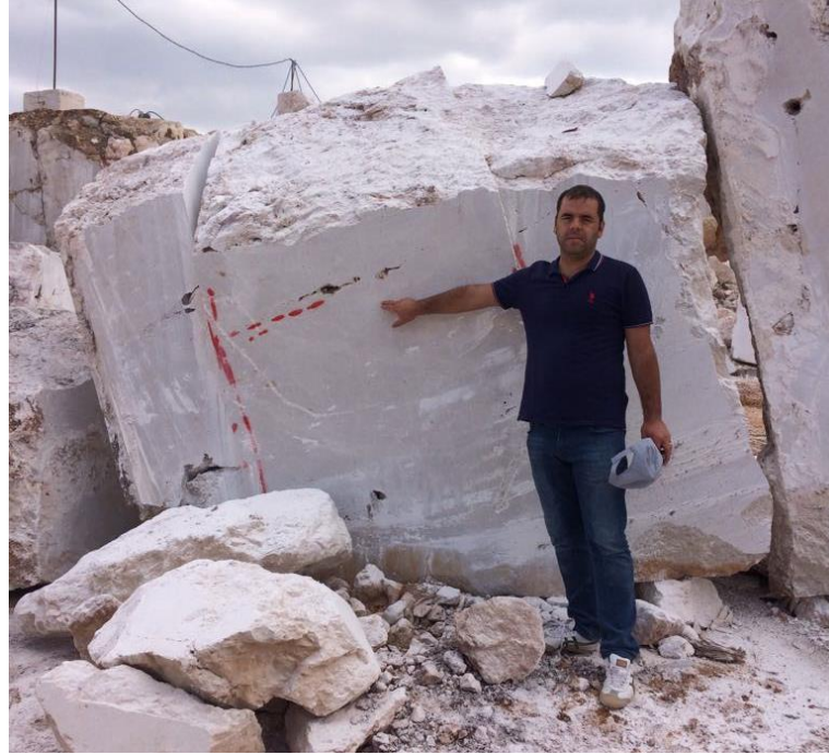
Şekil 1.2. İşlenmemiş bir mermer bloğunun ilk dağ kesim halinden görünüm
