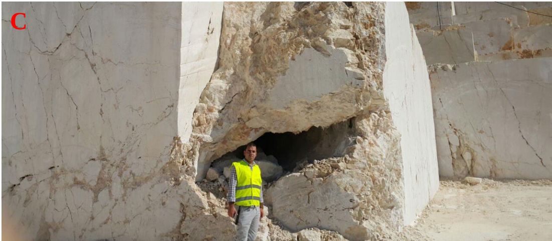
Şekil 4.56. Ergenli formasyonunun bej renkli kireçtaşı seviyelerinde yapılan ticari mermer üretimi sırasında karşılaşılan olumsuzluklar (A: Breşik yapılar, B: Aragonitleşme, C: Ocak kademelerinde görülen karstik boşluklar)
