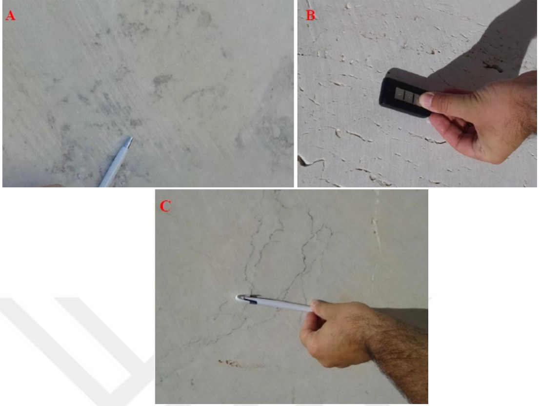
Şekil 4.18. Ocaklarda üretilen bloklarda görülen renk homojenliğini bozan yabancı madde girdisi (A), delikli yapı (B) ve siyah damarlı yapı (C)
