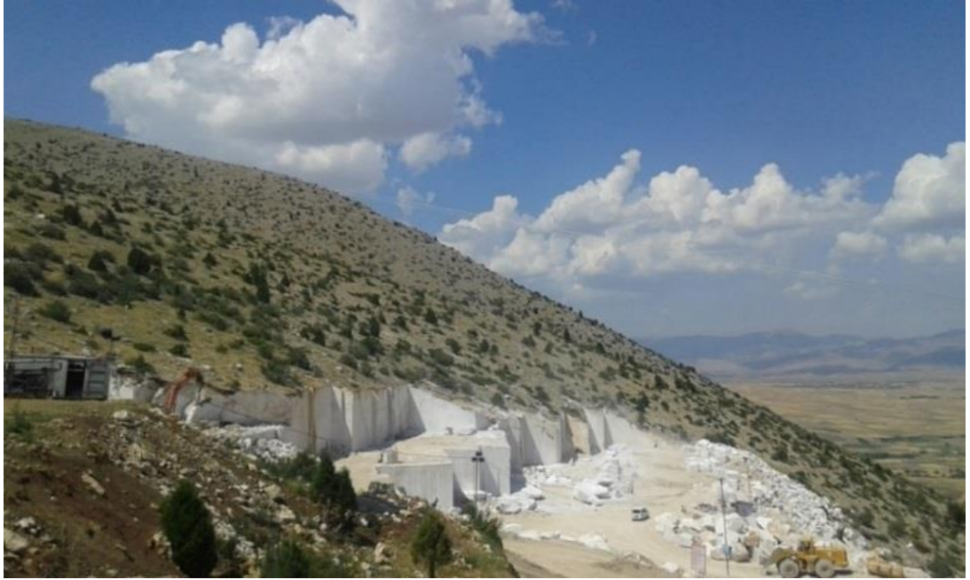
Şekil 4.30. Deliktaş formasyonunun dolomit seviyelerinde açılan ve ticari mermer üretiminin devam ettiği ocaktan görünüm (Ördekçi Köyü batısı)
