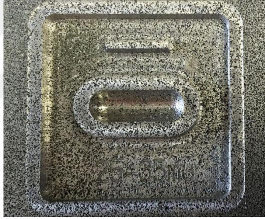
Şekil 3.16: Alüminyum köpük döküm kalıbı örneği (Exxentis 2021).
