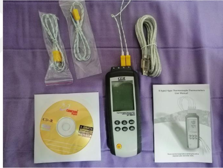
Şekil 4.32: Tedarik edilen sıcaklık kayıt cihazı ve propları.
