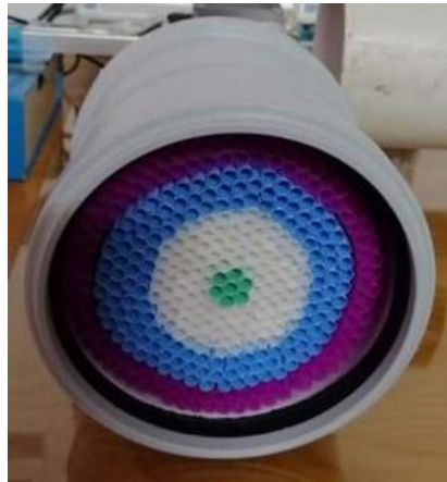
Şekil 4.28: Hazırlanan polipropilen yığına ait örnek görünüm.
