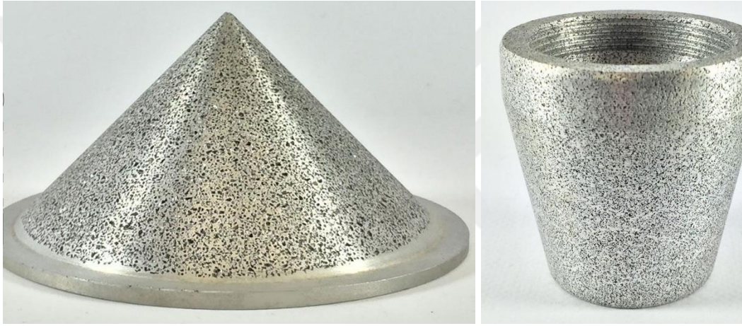
Şekil 3.19: Alüminyum köpük akışkan yatak örnekleri (Exxentis 2021).
