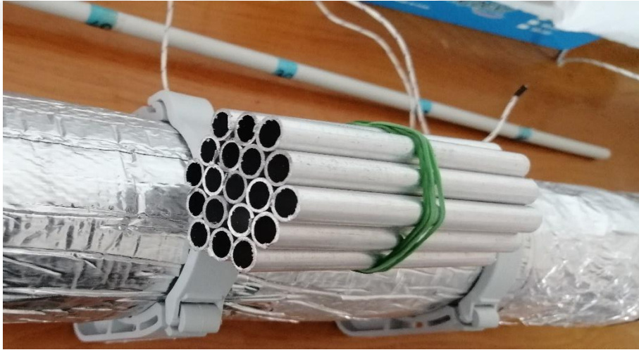
Şekil 5.19: Hazırlanan alüminyum yığının görünümü.
