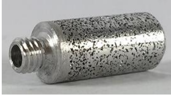
Şekil 3.17: Alüminyum köpük susturucu örneği (Exxentis 2021).
