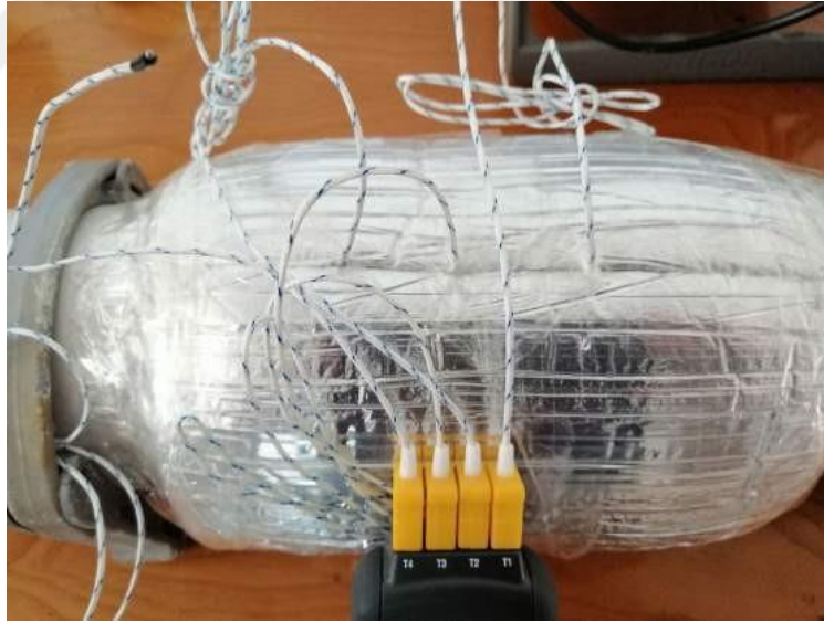
Şekil 5.2: Yığın etrafında yapılan izolasyon
