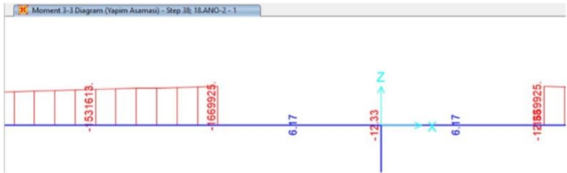
Şekil 3.64. Yapım aşamasında toplam yükten maksimum negatif eğilme momenti
