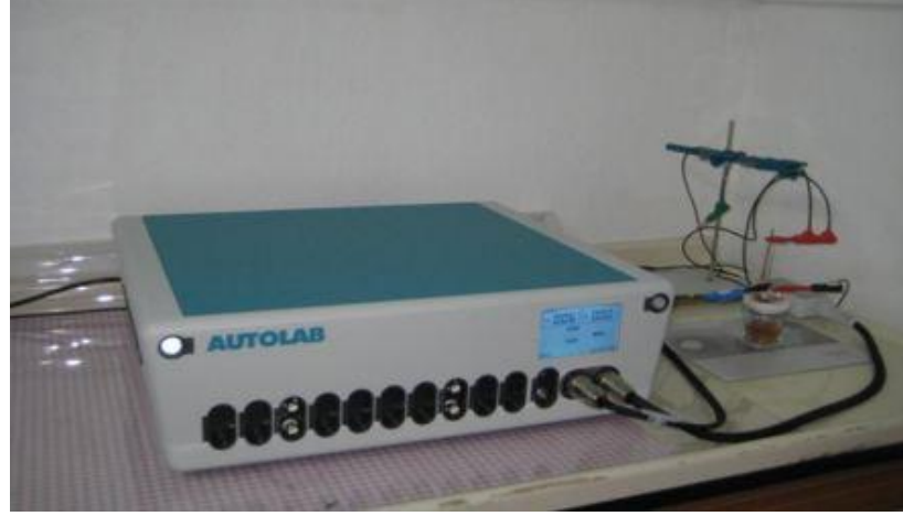
Şekil 3.1. Autolab Potentiostat/ Galvonostat PGSTAT-302N cihazı
