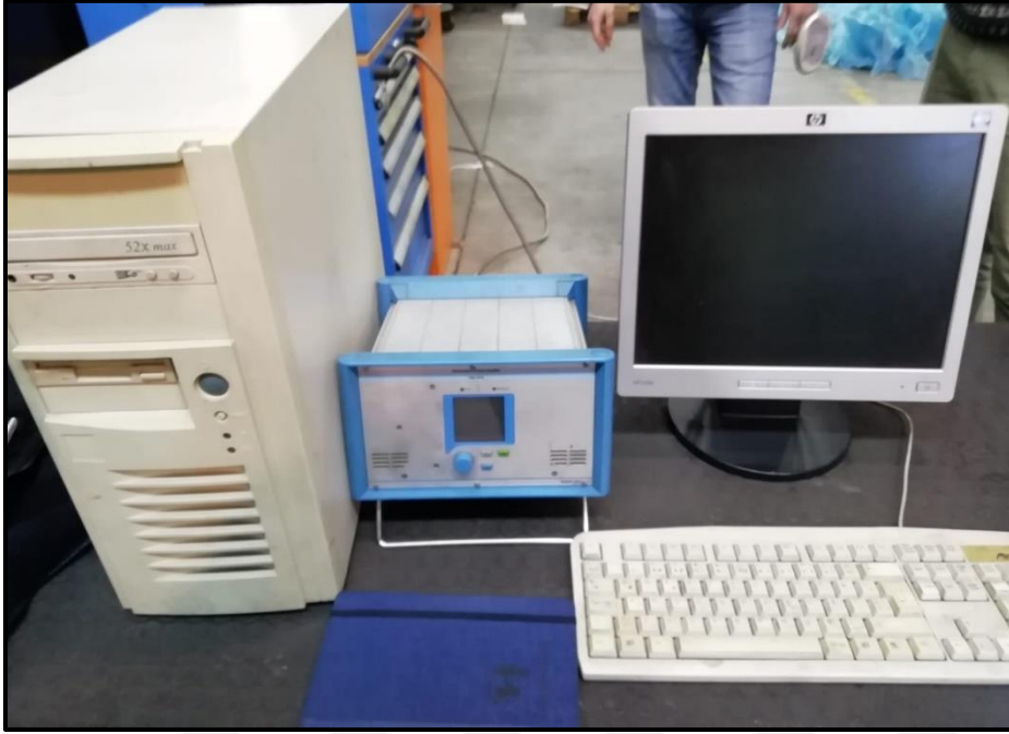
Şekil 4.16. Ölçümde kullanılan bilgisayar ve Kistler 5070 amplifier
