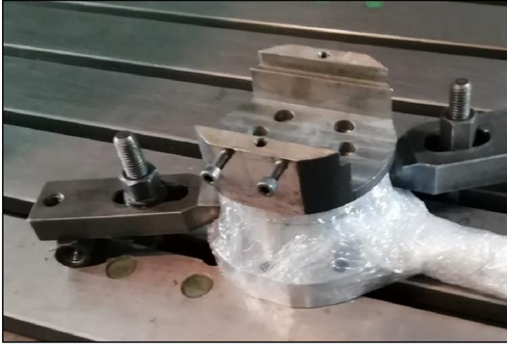
Şekil 4.17. Dinamometreye bağlanmış bağlama kalıbı ve dinamometre koruma
