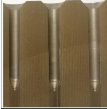
Şekil 4.14. Telli elektro erozyon ile kesim sonrası nozulların görünümü
