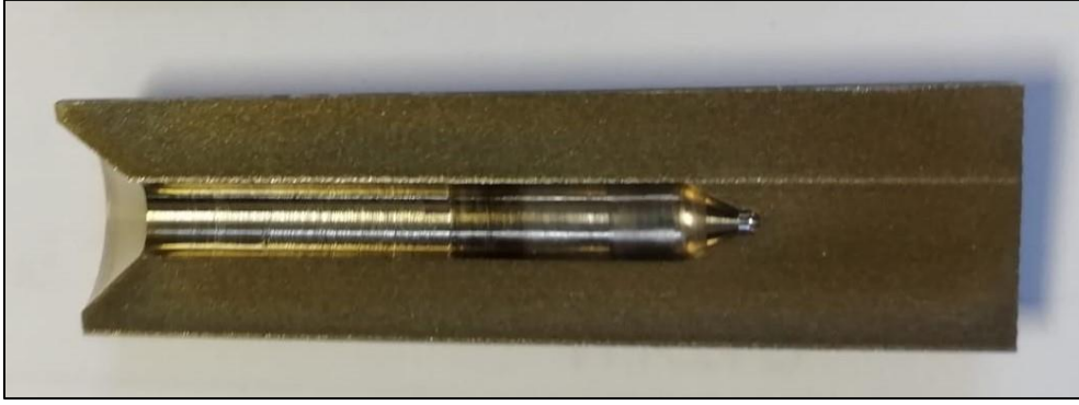
Şekil 5.35. Seri üretilmiş ve kesit görüntüsü alınmış nozul geometrisi
