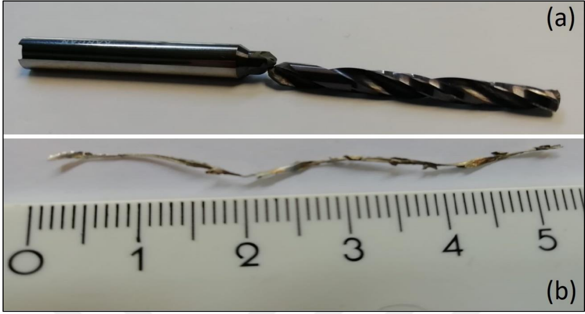
Şekil 5.17. (a) Kırılan ikinci takım ve (b) talaşı
