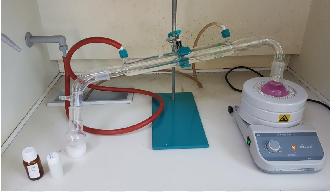
Şekil 22. Destilasyon ünitesi ile bir örneğin destile edilmesi
