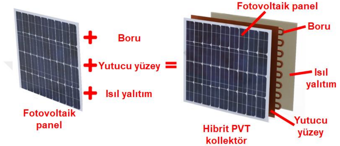
Şekil 2.9. Sıvı dolaşimli bir PVT kollektörün bileşenleri [22]
